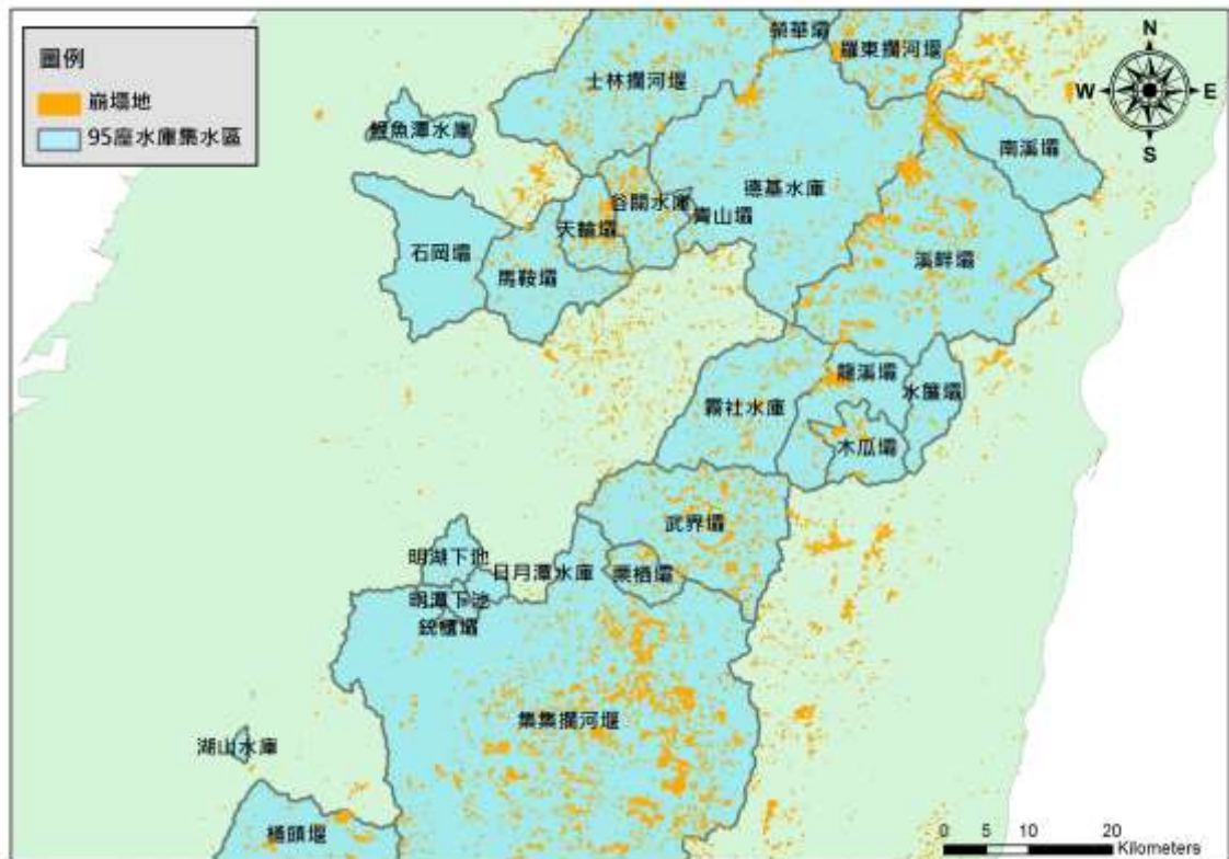
圖1-2 水庫集水區崩塌地分布_中部
