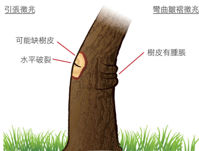
圖14 傾斜的樹幹有引張(左邊)及彎曲皺摺(右邊)兩種徵兆(林試所摺頁, 2012)
