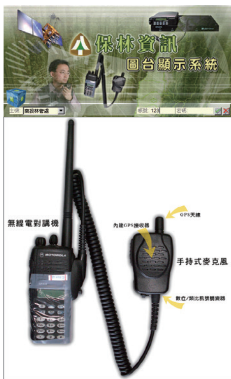
▲圖2、2006年建置之保林資訊圖台顯示系統，護管人員除應攜帶無線電對講機外，需外掛含電池之GPS手持麥克風。
