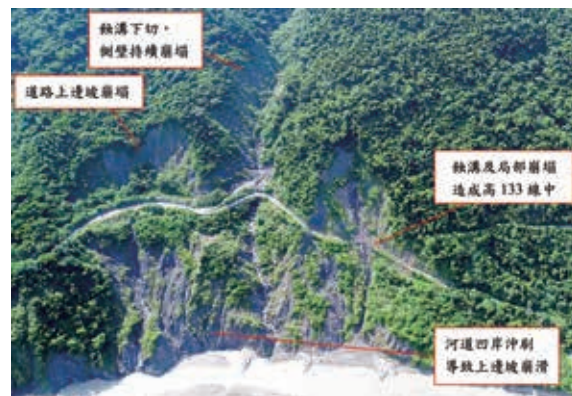
▲圖1、六龜區-D015高133線道路邊坡局部崩塌（林務局，105年）
