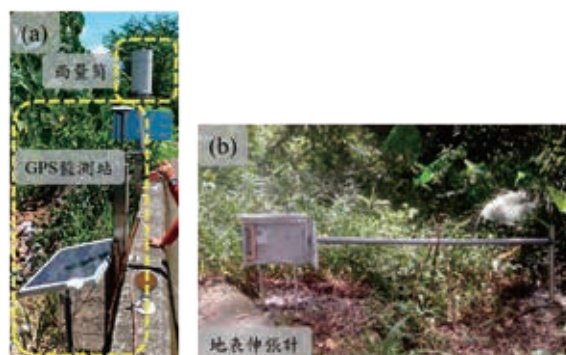
▲圖5、(a)GPS監測站及雨量筒，(b)地表伸張計。
