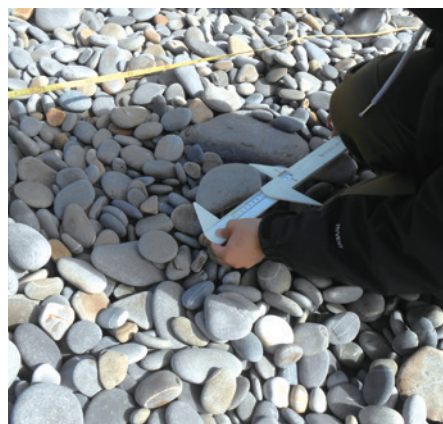
引導學生以測角器、捲尺、測量柱等記錄每段距離之角度，以繪出礫石灘的剖面圖，並記錄自海邊至岸邊的礫石尺寸。
