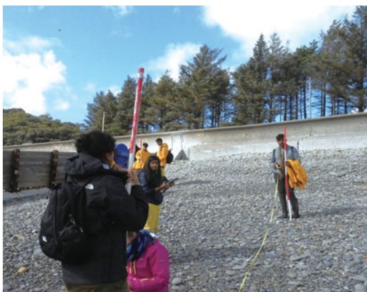
引導學生以測角器、捲尺、測量柱等記錄每段距離之角度，以繪出礫石灘的剖面圖，並記錄自海邊至岸邊的礫石尺寸。
