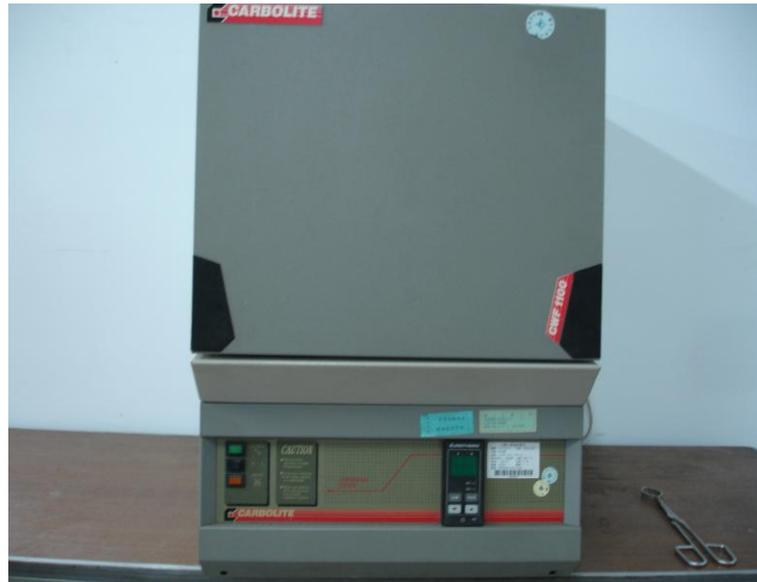
圖 5. 試驗所用灰化爐。
