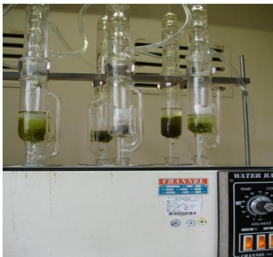
圖 6. 將水浴槽維持 85 °C 使溶液沸騰每小時約產生 6 次虹吸。
