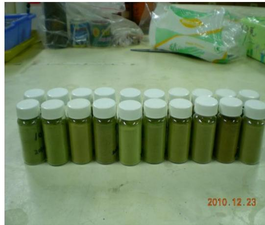
圖 4. 20 種葉片絕乾後磨粉裝瓶。
