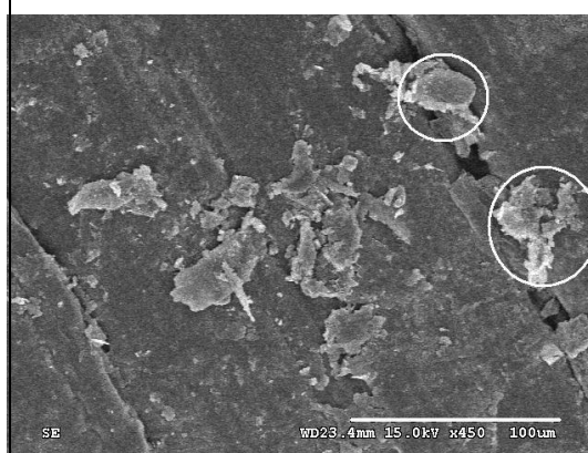
圖 30. 沙塵微粒停滯於麻竹之葉面。
