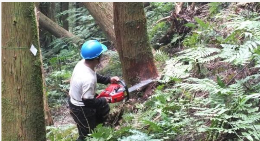
照片 2. 伐木 - - 利用鏈鋸進行立木伐倒作業
