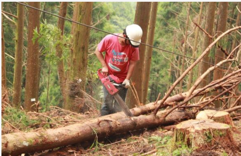
照片 4. 造材 - - 長幹材之造材截斷作業
