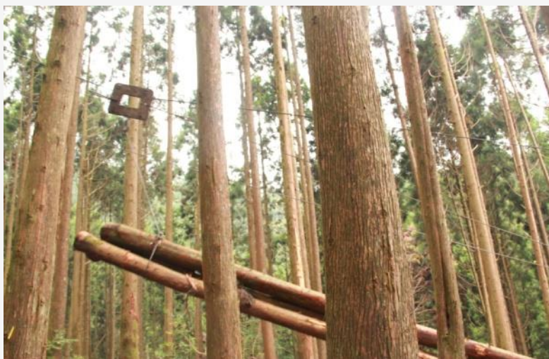
照片 3. 集材 - - 長幹材疏伐木之集材作業
