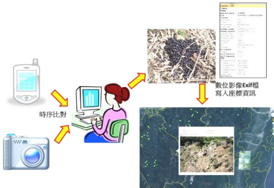
圖 2-7：調查沿途直擊動物或發現動物之排遺、屍體、爪痕等跡象，則以數位相機結合全球衛星定位進行紀錄座標資訊於數值照片上，可展繪於地圖上。
