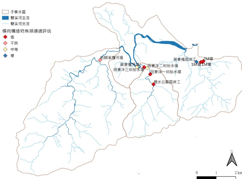
圖 4.2-20 雙溪下游水系的魚類通過評估結果
