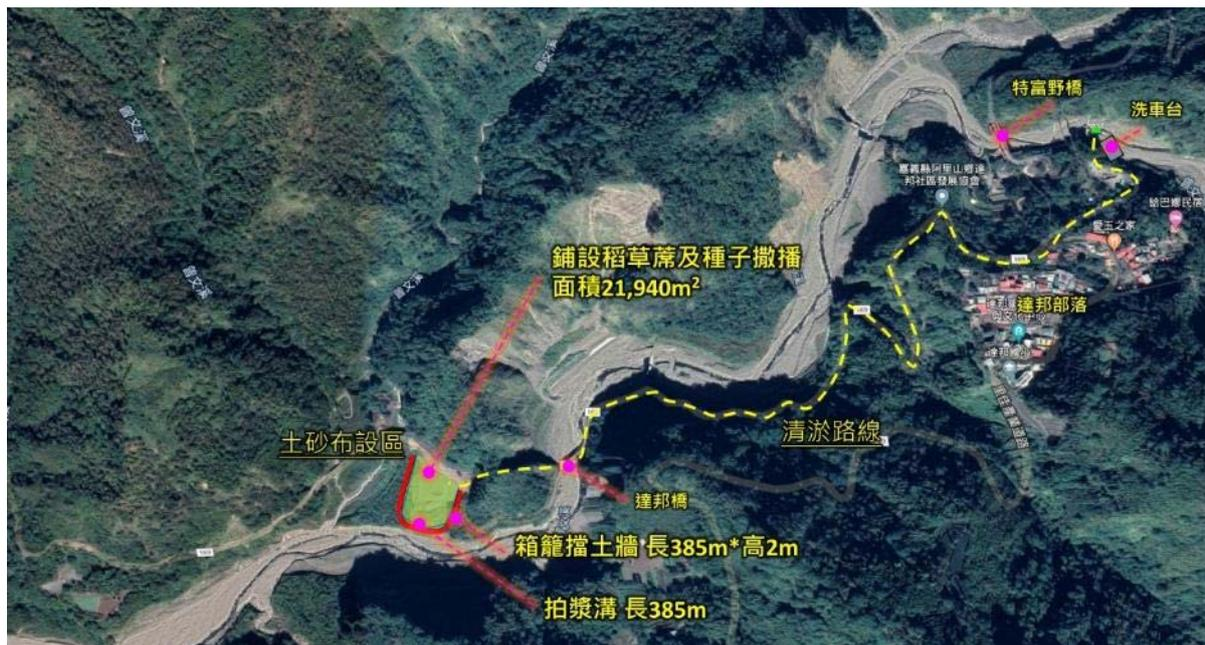
圖 4-44 達邦壩清淤工程第二期工程土砂布設區配置詳圖
