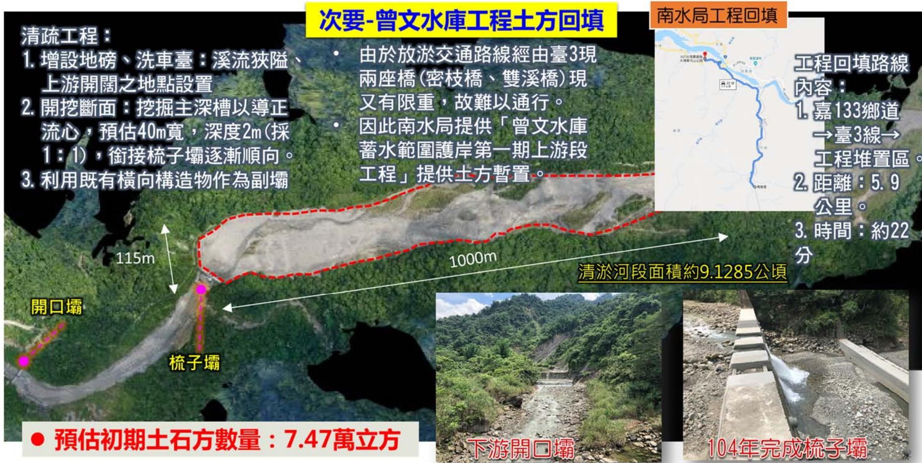
圖 4-38 鄰近曾文水庫工程土方回填方案上游段工程區位圖
