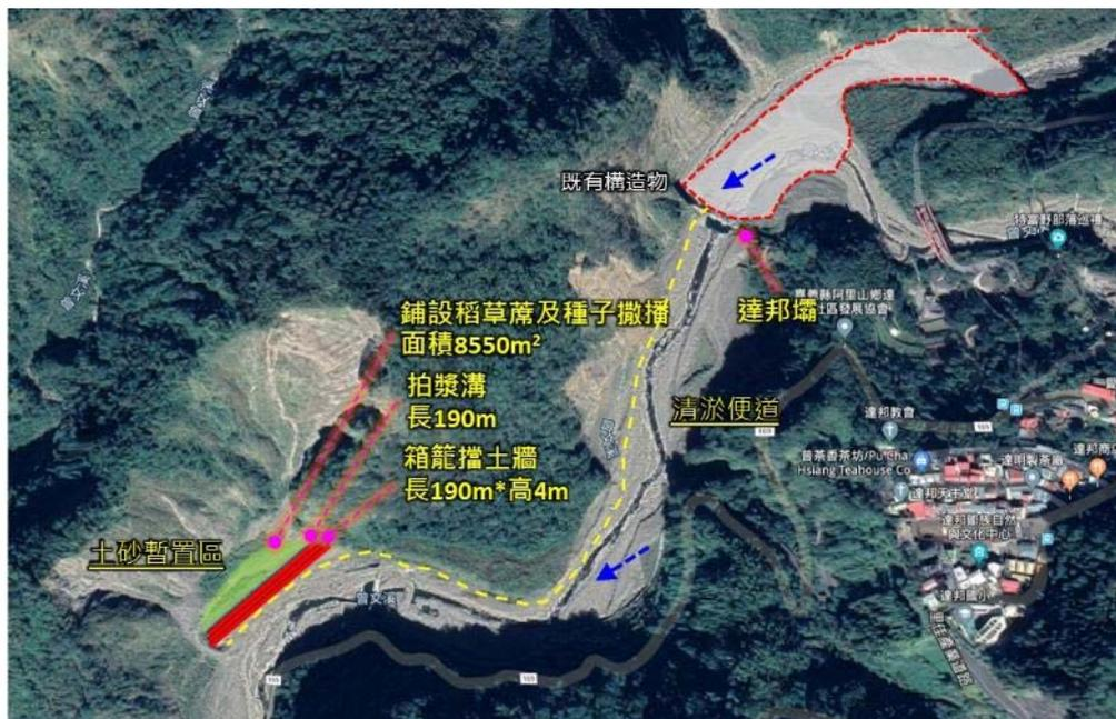
圖 4-42 達邦壩下方河段崩塌地處理土砂穩固配置詳圖
