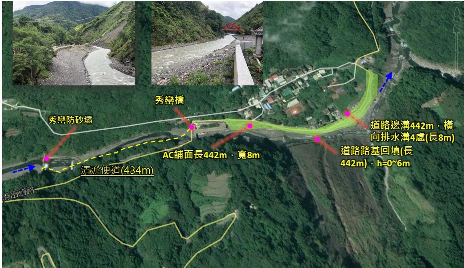
圖 4-29 秀巒壩上游區段土砂堆置區配置詳圖
