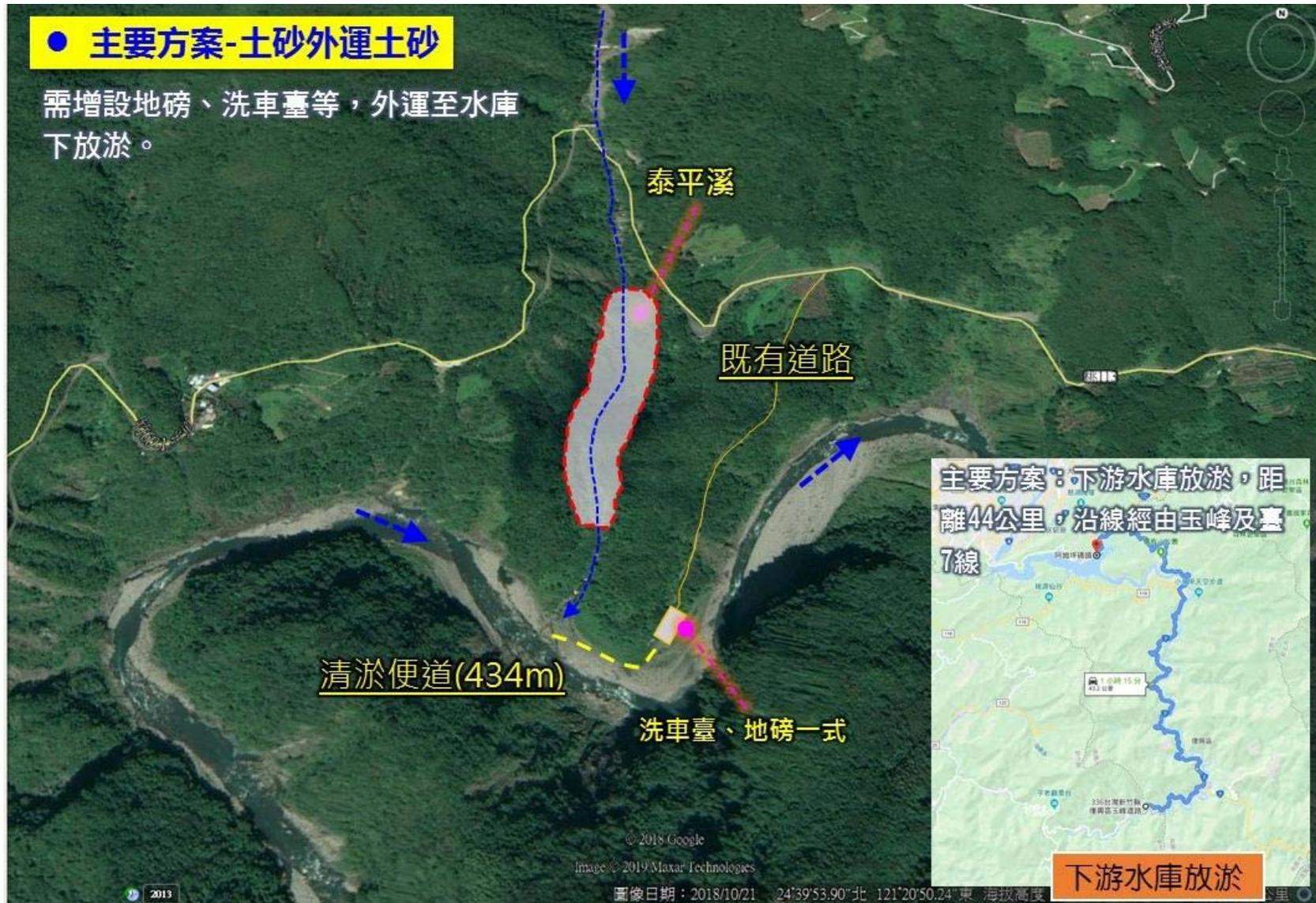
圖 4-33 泰平溪河道區段第一期工程土砂布設區配置詳圖
