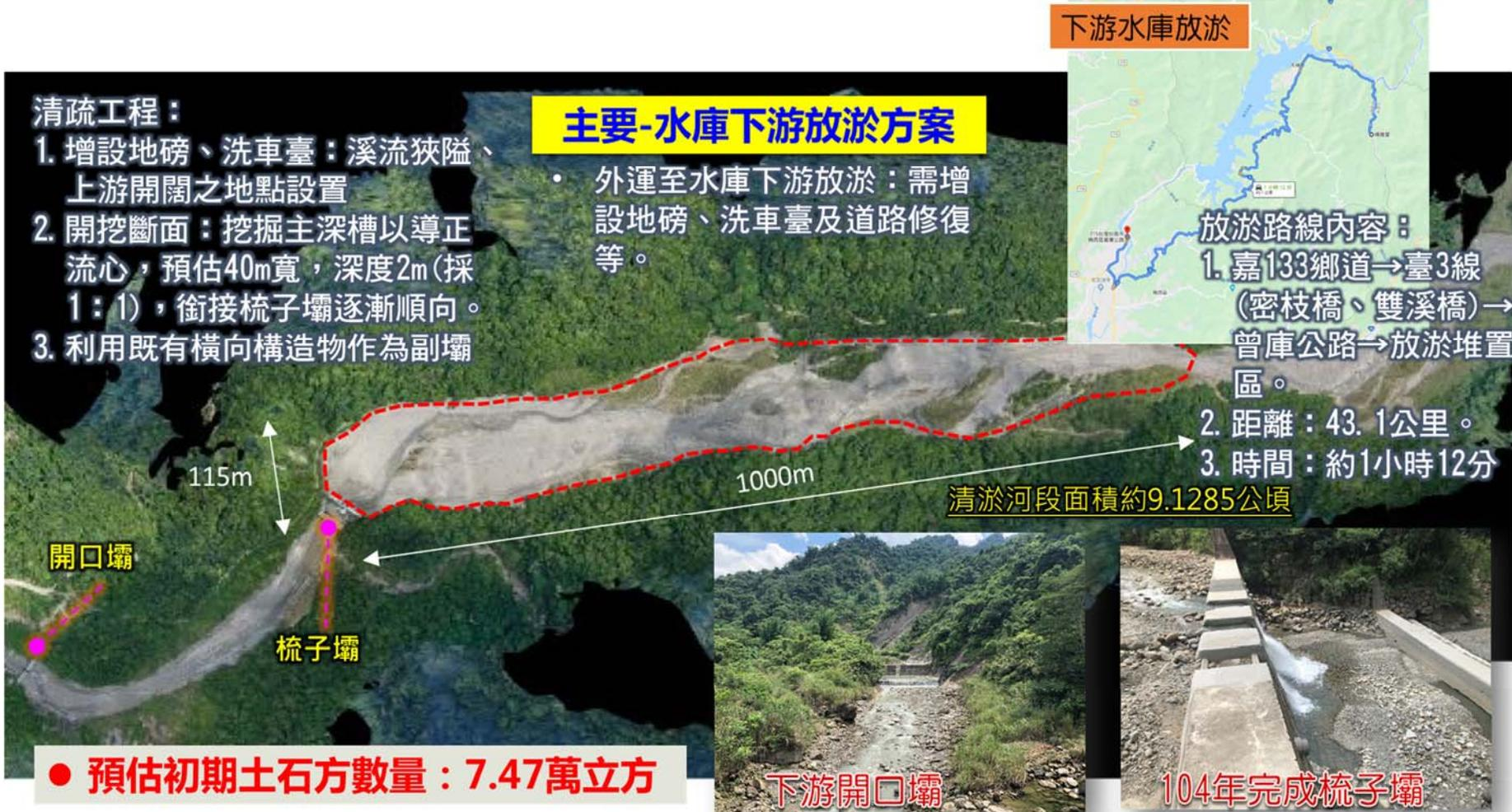
圖 4-36 草蘭溪(大埔區第 92 林班災害治理工程)上游區段清疏工程回歸下游河道配置詳圖
