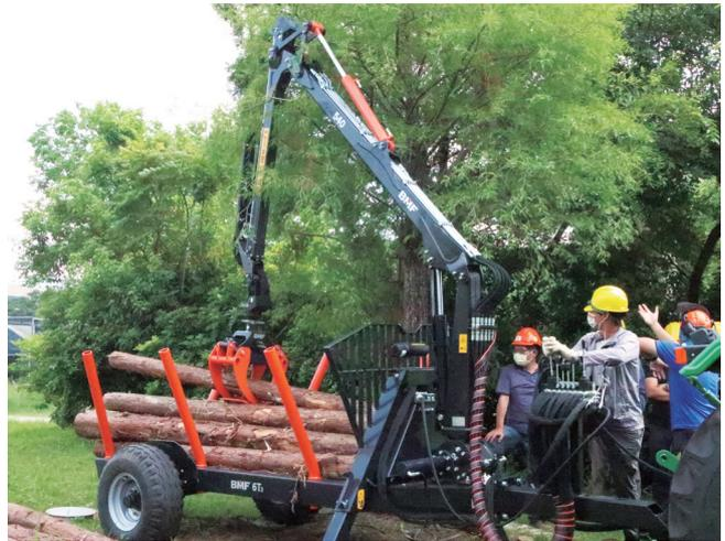
利用塔式集材機與裝載式運材拖車進行集材與裝運材，提升國內林木收穫作業效率。
