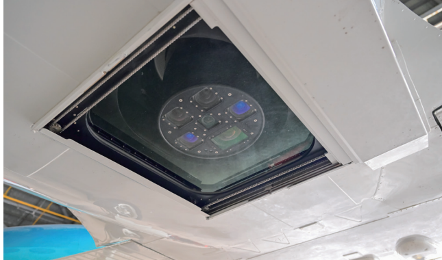
△ 新型高解析度航攝數位相機(DMC III)完成安裝
