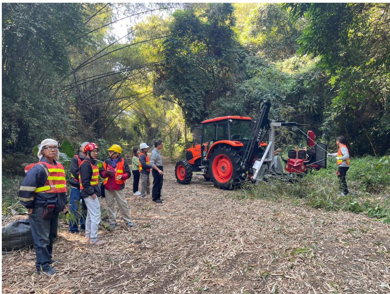
▲竹材收穫應用曳引機帶動之造材機實地演練
