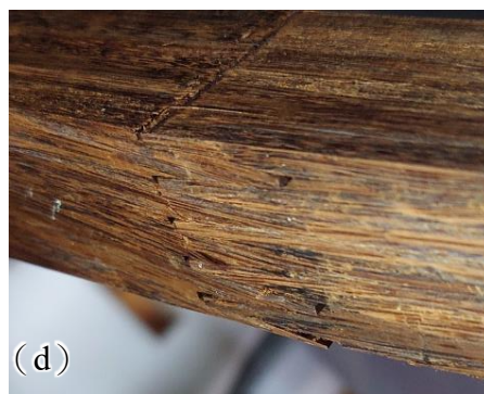
圖 4、指接集成元之破壞型態。(a) 破壞於指接處以外之部位；(b) 破壞於指接處及指接處以外之部位；(c) 破壞於指接處，引張側指樺斷裂；(d) 破壞於指接處，引張側指樺鬆脫而未發生斷裂現象。
