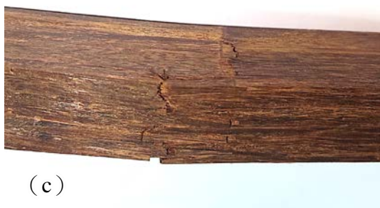
圖 4、指接集成元之破壞型態。(a) 破壞於指接處以外之部位；(b) 破壞於指接處及指接處以外之部位；(c) 破壞於指接處，引張側指樺斷裂；(d) 破壞於指接處，引張側指樺鬆脫而未發生斷裂現象。
