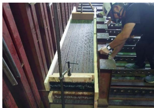
圖 3、束狀竹層積材集成材之層積方向冷壓作業。
