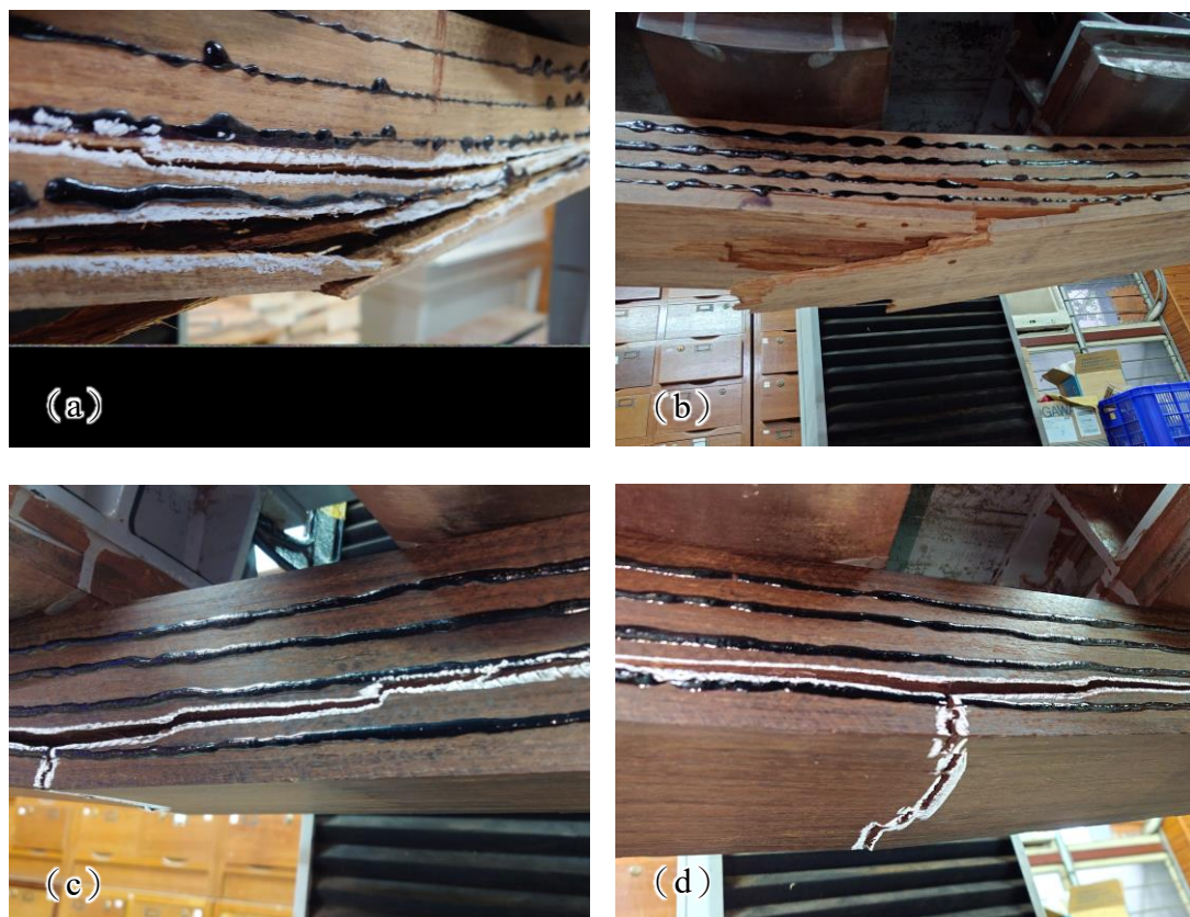
圖 7、束狀竹層積材集成材之破壞型態。(a) 束狀竹層積材集成材層間破壞於材料，未出現層間剝離現象；(b) 束狀竹層積材集成材引張側破壞呈現纖維撕裂狀；(c) 熱處理束狀竹層積材集成材層間破壞於材料，未出現層間剝離現象；(d) 熱處理束狀竹層積材集成材引張側發生脆性破壞。
