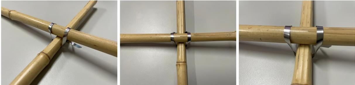
圖45：不鏽鋼束帶試作
