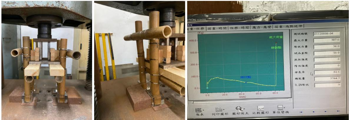
圖83：B-1束帶接頭抗剪試驗
