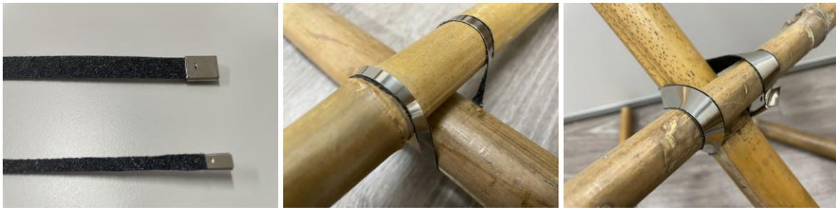
圖69：不鏽鋼束帶摩擦力改良-磨砂防滑膠帶
