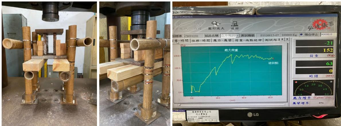
圖84：B-2束帶接頭抗剪試驗
