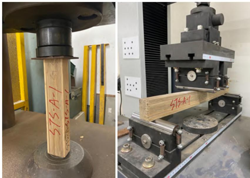
圖104：抗壓及抗彎試驗示意圖（左：抗壓，右：抗彎）
