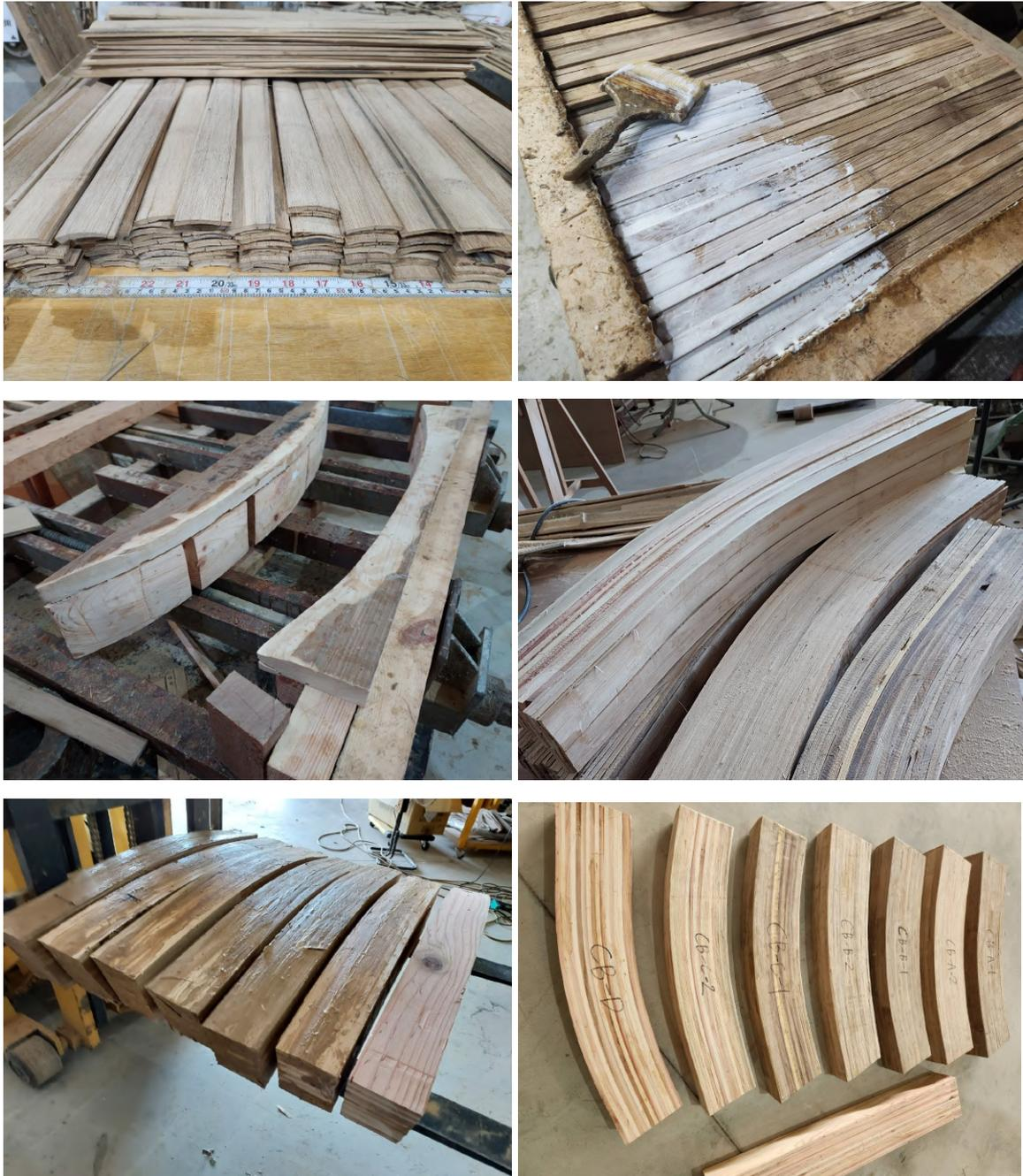
圖105：集成曲線竹樑之prototype製作過程
