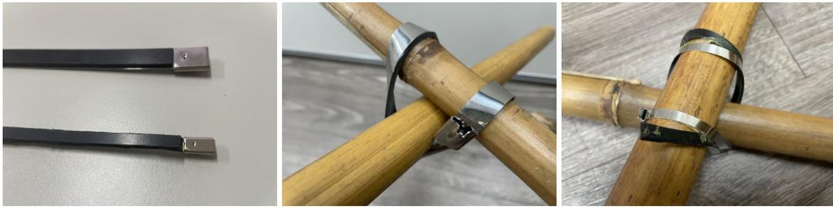
圖68：不鏽鋼束帶摩擦力改良-橡膠
