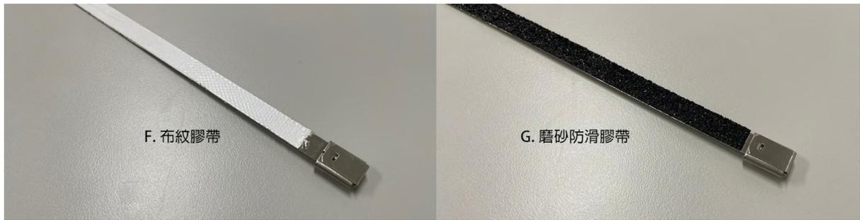
圖49：不鏽鋼束帶摩擦力改良-F. 布紋膠帶、G. 磨砂防滑膠帶
