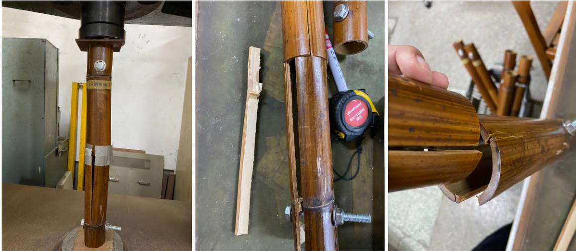
圖95：A續接接頭抗壓試驗
