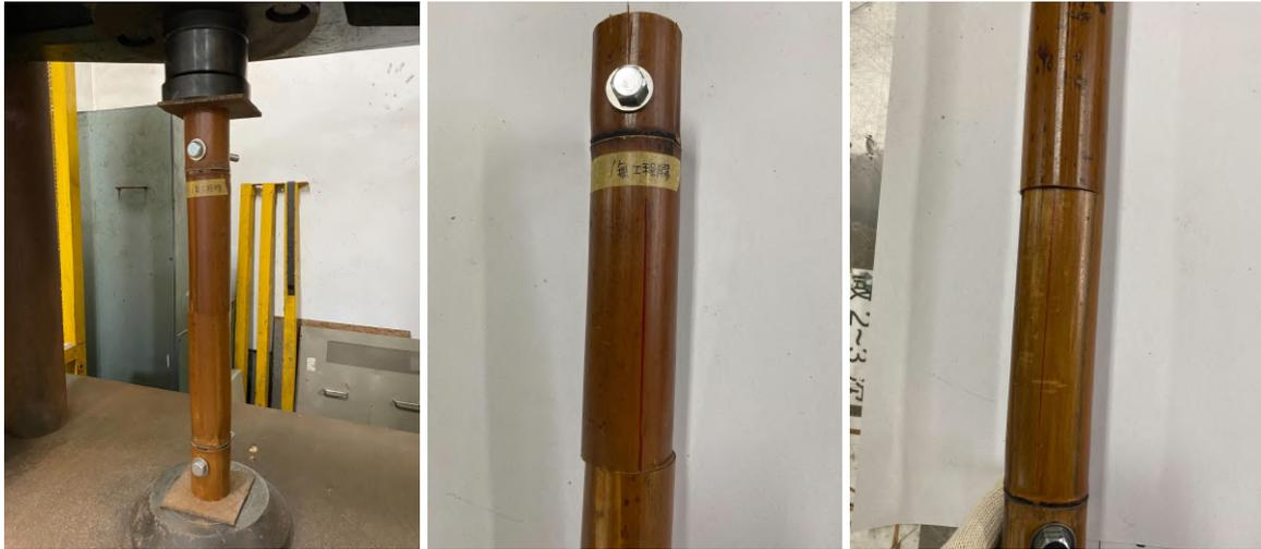
圖97：B續接接頭抗壓試驗
