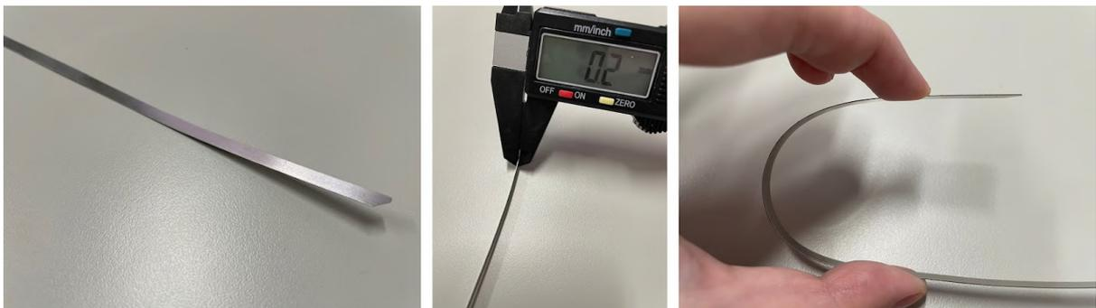
圖44：交疊接頭雛形材料選用（0.2mm不鏽鋼）
