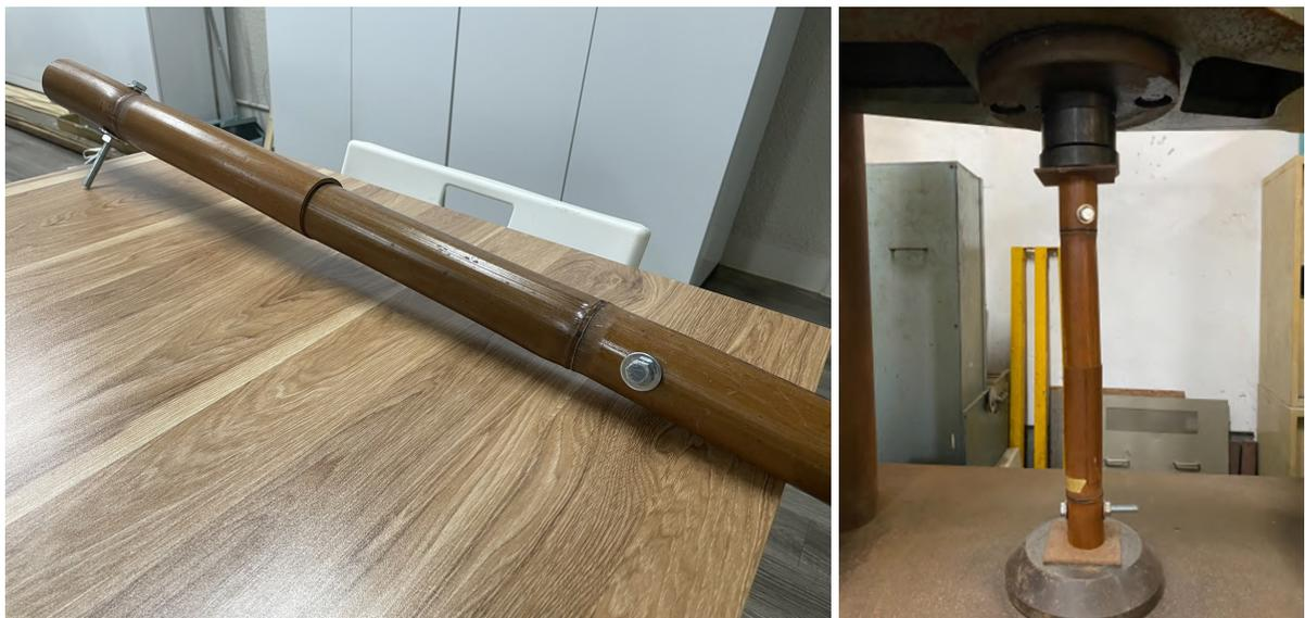
圖94：續接接頭試體外觀及試驗示意圖
