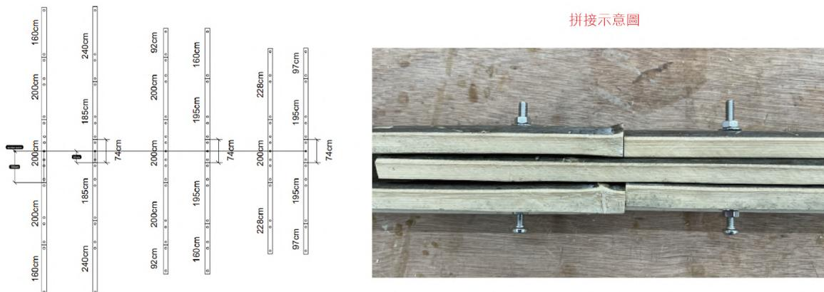
圖120：彈性網殼第三次實作竹材拼接示意圖
