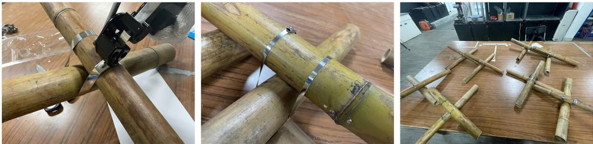
圖74：A束帶接頭試體製作過程紀錄
