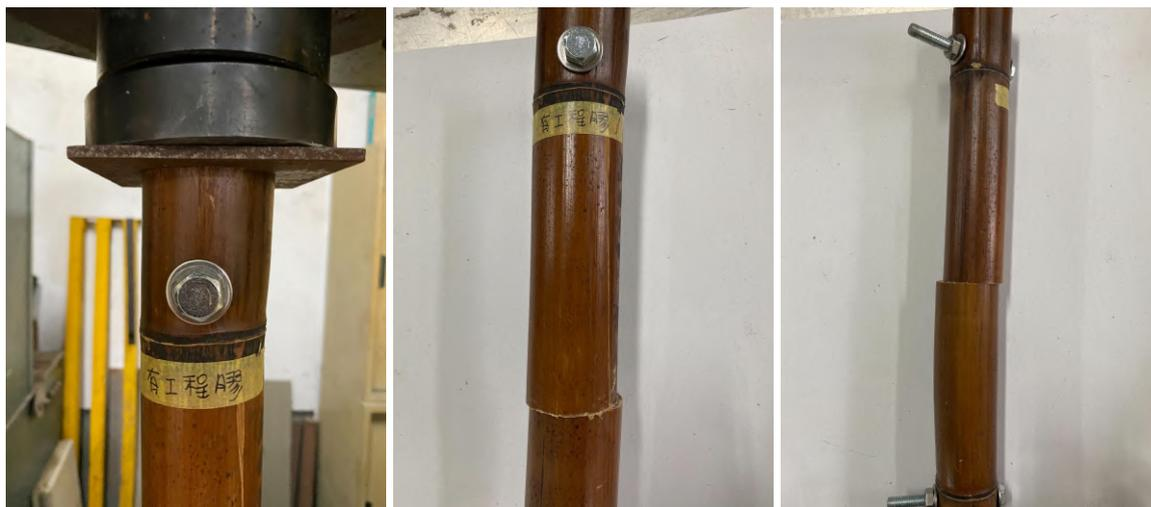
圖99：C續接接頭抗壓試驗
