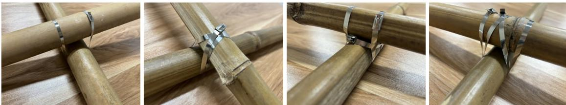
圖65：四種不鏽鋼束帶綁紮方式
