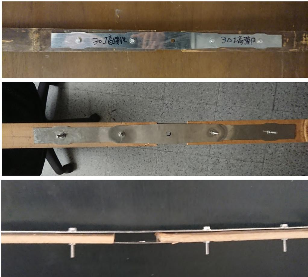
圖132：彈性網殼第四次實作軸向續接prototype
