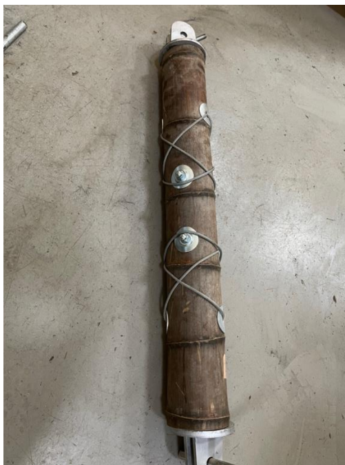
圖 8.18 鋼索預拉螺栓接合
