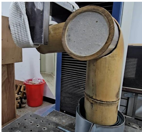
圖 9.30 RC 灌注補強之竹包管試體
