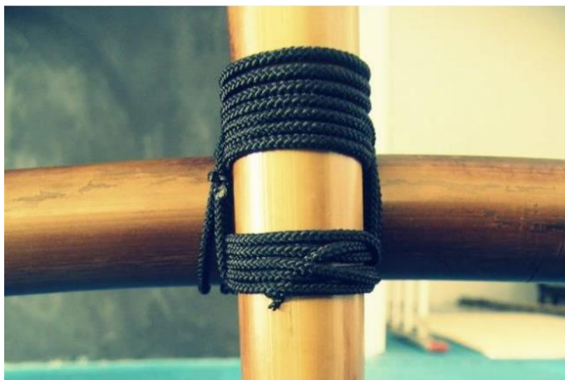
圖 8.13 以尼龍繩綁紮接合之不共平面接合[21]
