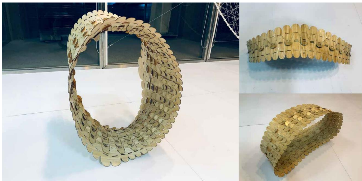
圖 8.17 竹片榫接的新式構造接合方式
