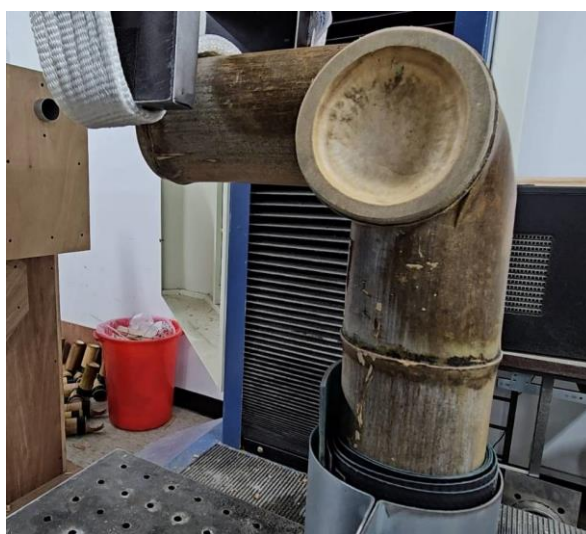
圖 8.19 竹包管抗彎接合
