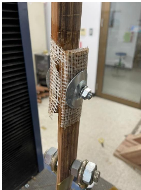
圖 9.35 試驗過程玻璃纖維斷裂情形
