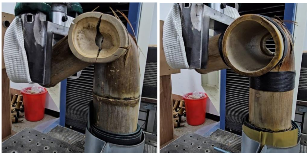
圖 9.29 無圍束及有圍束竹包管於受包覆竹材開裂後之變形狀況
