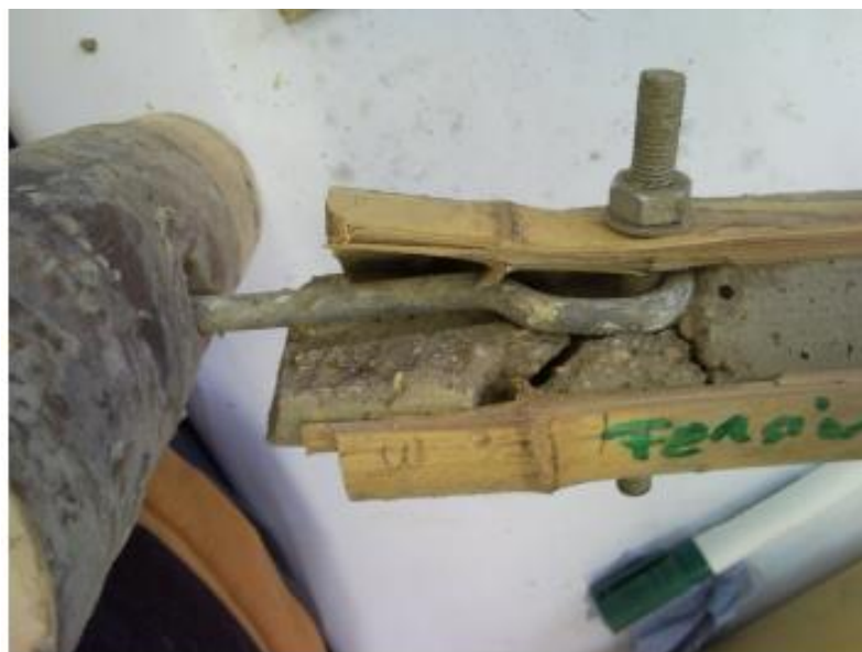
圖 8.6 填充混凝土之竹構接合[23]
