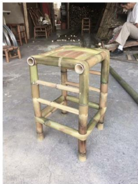
圖 8.16 竹包管結構接合方式
