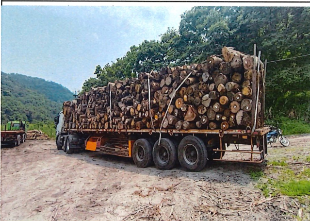
(5) 林道0K+100路面原碎石級配路面多年流失未補充，板車載運約31~35噸左右，易甩車頭及打滑 座標：X：283241；Y：2600575。
