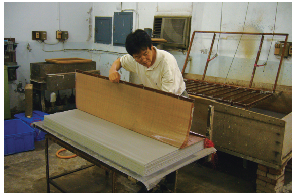
▲在水槽中抄紙完畢後，必須將網篩上的雛型紙一張張地取下。
