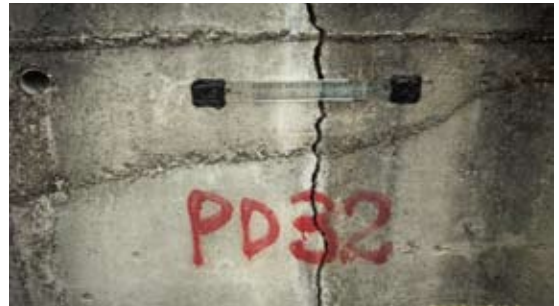
(1)簡易式裂縫計之安裝示意
