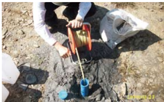
(1)水位量測放入水位指示器
