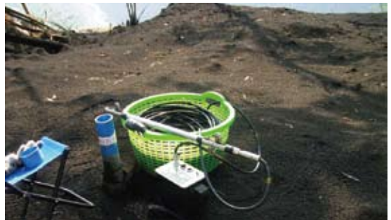
(2)傾斜儀沿凹槽放入管中，兩軸各量一次。
