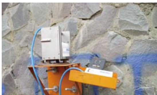
(2)將儀器置於固定盤量測後，再旋轉量測方向。
