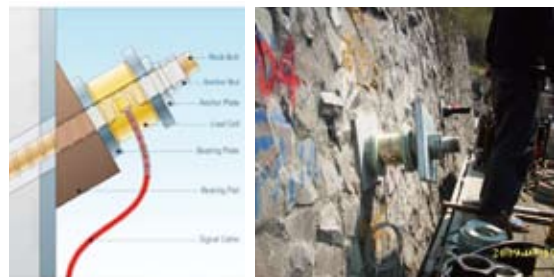
(1)地錨荷重計詳圖(摘自 Geokon型錄) (2)地錨荷重計量測照片
