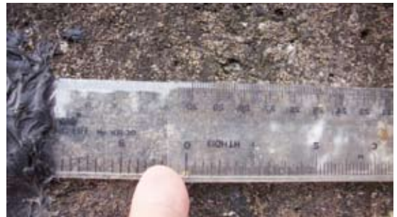
(2)簡易式裂縫計之測讀示意
