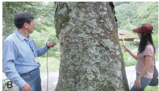
圖1 現場進行打音檢測評估之情形
