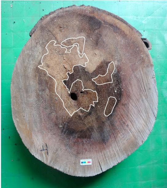
圖3 編號2山黃麻實際檢測位置之橫斷面，白線圈出之範圍為腐朽之位置，面積率約為14%。
