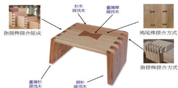
▲圖7、「輕設計」的產品設計實例—小椅機設計為例
