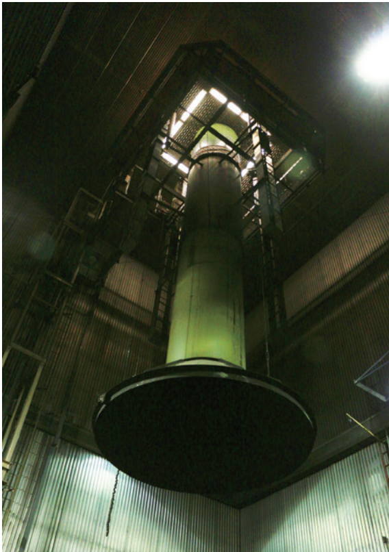
▲圖3、環境控制燃燒室－煙霧蒐集設備
