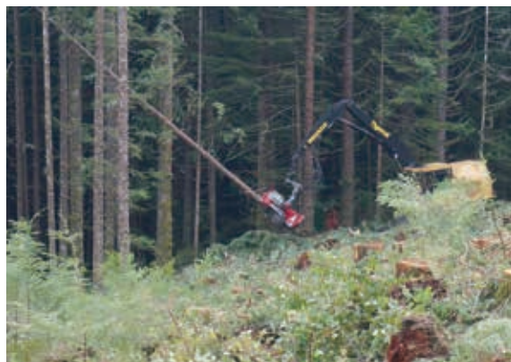
▲ 一名技術人員即可操作收穫機執行伐木及集材，大幅降低人力工資及作業風險。
