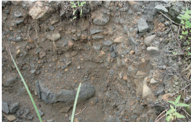
■ 圖 5. 崩塌坡面之中、上坡段，自然重建之植生分布不均且植株矮小，在坡腳土石堆積區所栽植苗木生長不佳（左）。主因為土壤比例太低（右），未能供應苗木生長所需。
