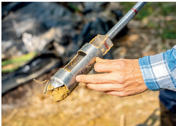
■ 田間採樣不同深度的土壤，檢測巨量、微量元素、酸鹼值等成份。
