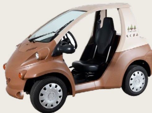
由秋田 COI-NEXT「創造之森」運用多種不同性質的木質材料所製成的車殼。（圖片來源：Toyota Auto Body）
