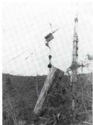
▲太平山之多徑間一段長距離集材，木材將通過中間支架
