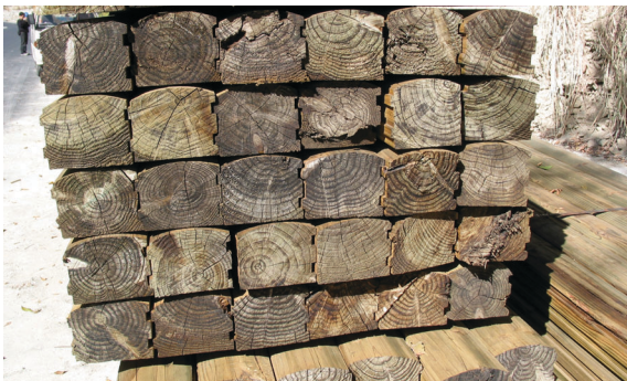
圖12 ACQ防腐處理D-Log原木
