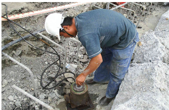
▲照片7 土釘拉拔試驗（切頭、加套）。
