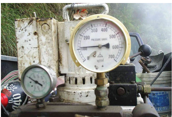
▲照片8 土釘拉拔試驗（加壓、判讀）。
