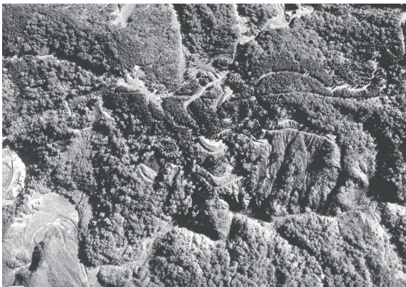
▲照片6 民國74年10月：中間地區已完成道路整地開發，受其道路開闢影響，局部道路邊坡有產生崩塌情形。道路及下方野溪之間所形成之沖蝕溝有更加擴大情形，中間解說站東側，亦有較大之向源侵蝕現象產生。
