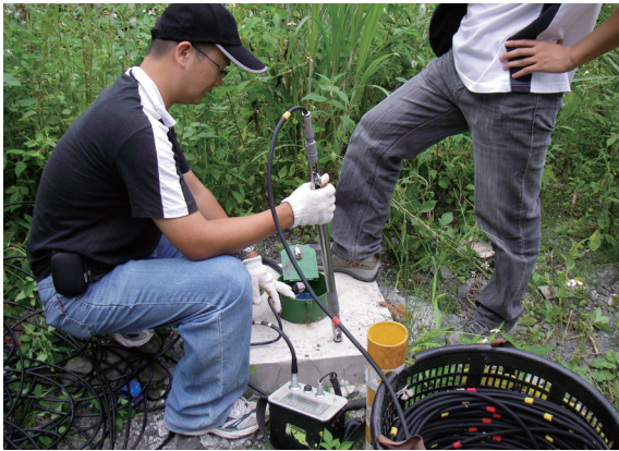
▲照片9 雨量、地下水位、傾斜觀測。
