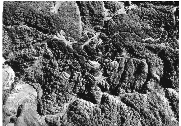
圖3 1985年10月：中間地區已完成道路整地，局部邊坡有崩塌。道路及下方野溪之間所形成之沖蝕溝有擴大。
