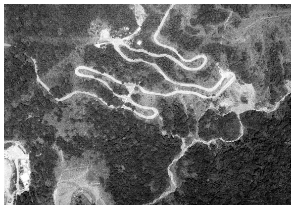
圖4 1992年7月：由航照明顯看出林道路線已無使用，車輛主要以新闢道路為主，其道路及下方野溪之間所形成之沖蝕溝有更加擴大。
