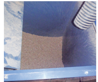
圖15 再生質能源機器中，木材能源燃料填入口。
