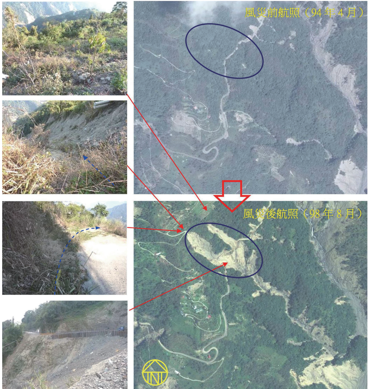
圖2 藤枝聯外道路12.6K寶山二號橋基地之莫拉克風災前後狀況
