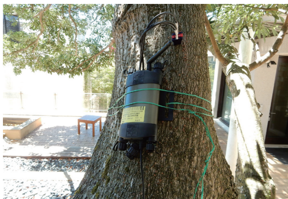
檢測樹木健康狀況，除了目視診斷，也可以結合科技儀器。例如使用樹液流動儀，可了解維管束樹液流動狀態，應用於評估了解樹木健康情形。
