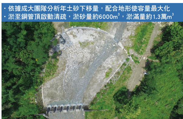
圖8、規劃土砂緩衝區，沉砂緩流。
