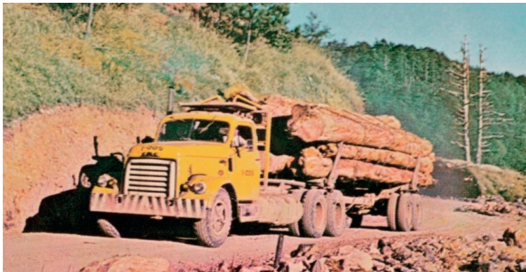
■ 大雪山林業公司的美式聯車可載運 20 餘公尺長的原木，載重量高達 25 - 29 立方公尺，約為當時日式卡車的 5 倍。（照片出處 / 《大雪山林業史話》）
