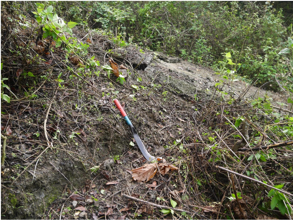
照片 3-4.66、調查點 8 主崩崖發育並切過農路，崩崖高差約 60 公分。
