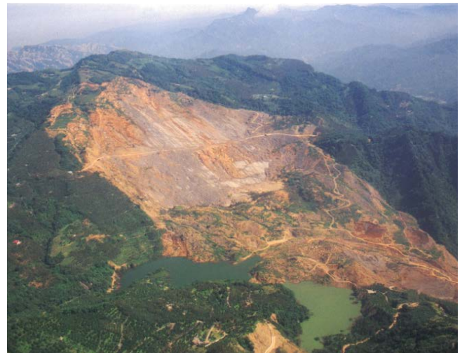
圖 2-4.5、順向坡之平面型破壞示意圖與案例影像。
