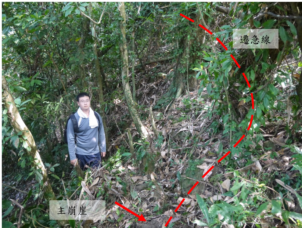
附錄照片 2、調查點 05 為主崩崖，崖面甚陡，遷急線明顯。
