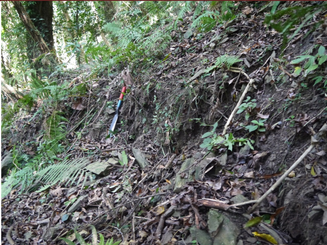
照片 3-4.4、調查點 14 內部近期發育之小型崩崖，崩崖高差 60 公分。
