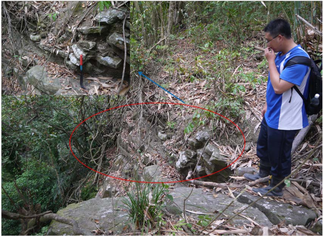
照片 3-4.49、調查點 01 平緩層面的砂岩體，與坡頂岩盤層面位態差異大，顯示此砂岩體為頂部滑移下來或岩體發育褶曲。
