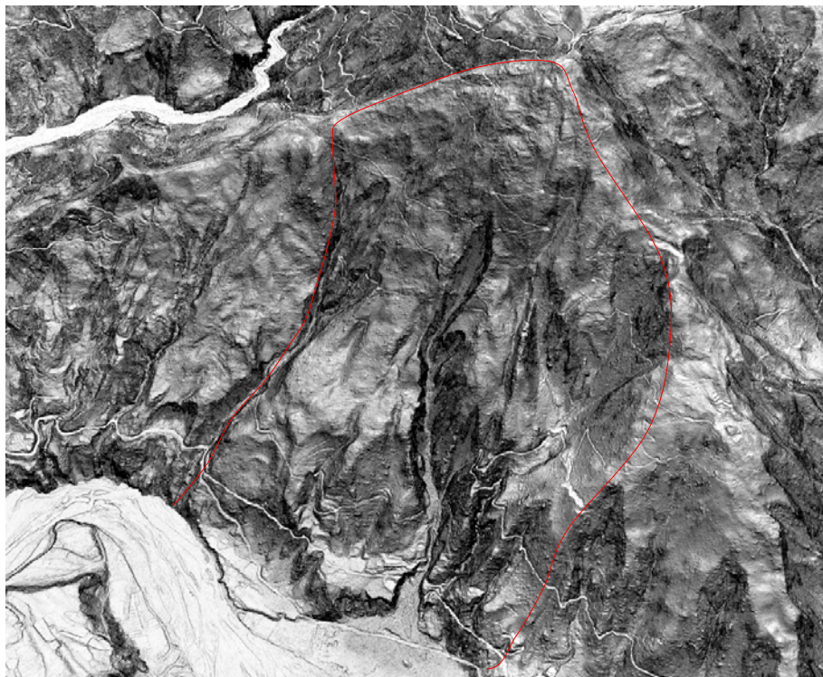
圖 3-4.49、崩塌地編號高雄市-六龜區-D015 立體圖，紅線為潛在崩塌範圍。
