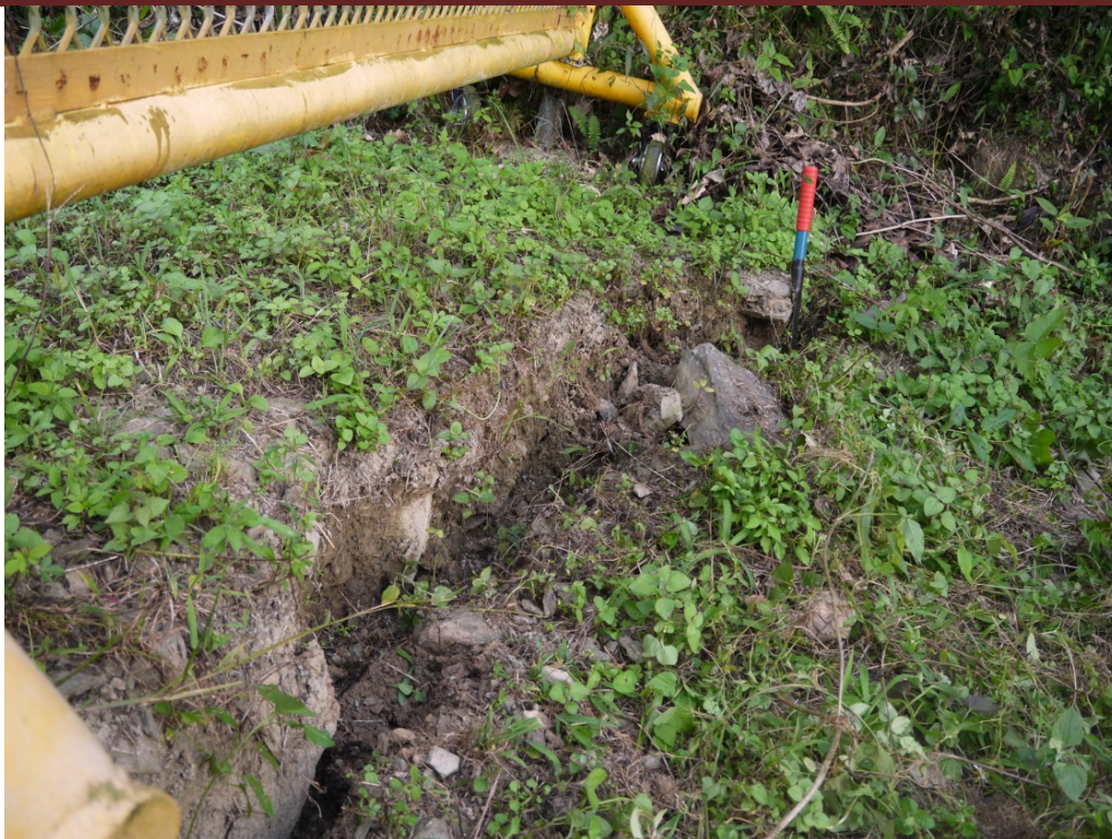
照片 3-4.10、調查點 8 為主崩塌附近的裂隙，裂隙高差約 40 公分。
