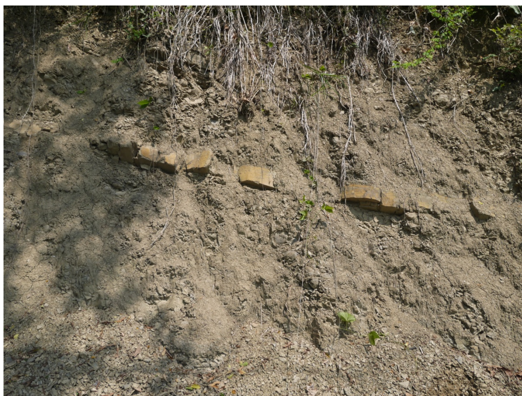
照片 3-4.52、調查點 041 岩盤位態( N80^{\circ}W , 35^{\circ}N )，與大區域地層位態差異甚大。
