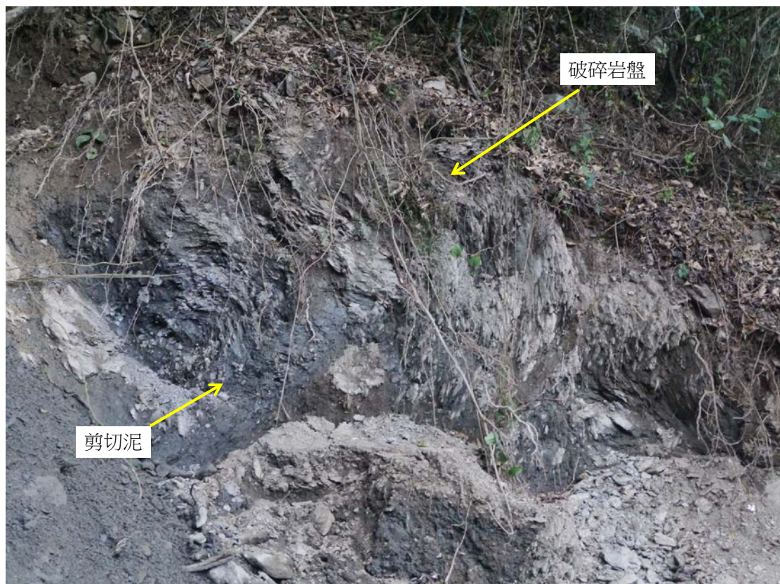
照片 3-4.82、調查點 11 剪切泥圍岩為風化岩盤，岩盤有許多開口，表示此剪切泥為岩盤重力滑動所形成。
