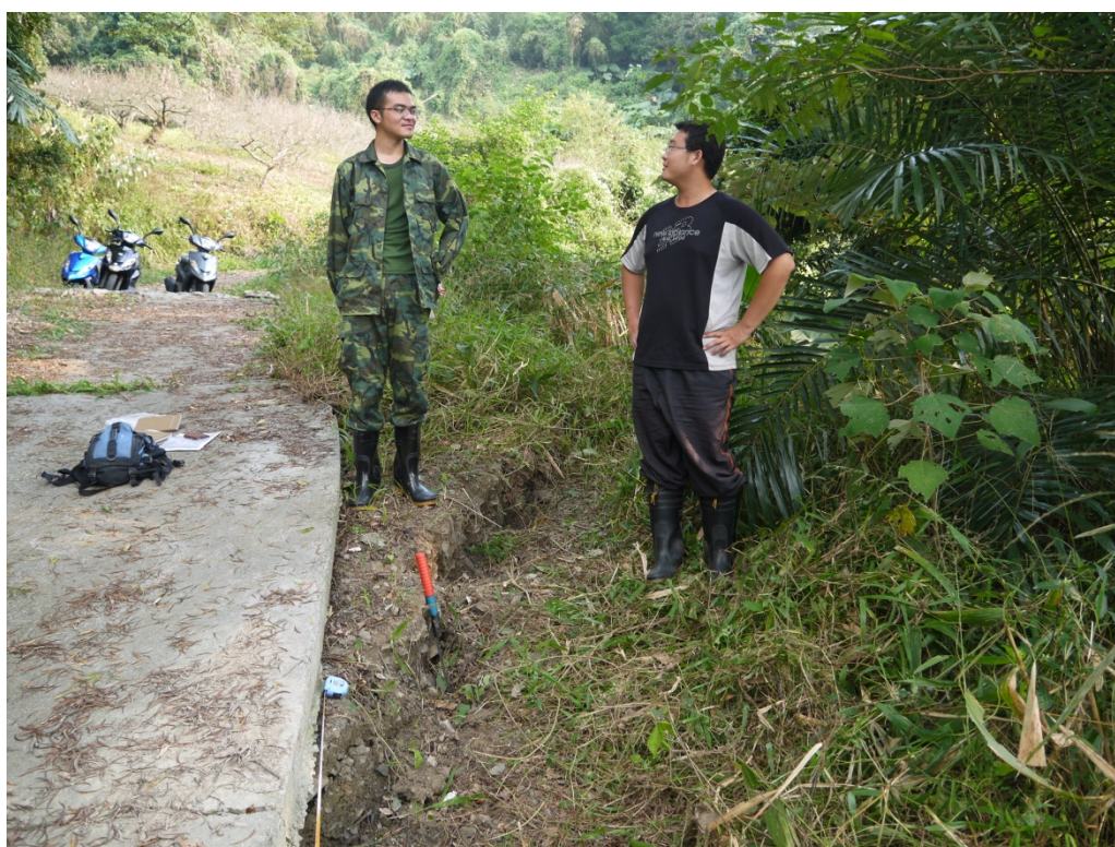
照片 3-4.8、調查點 7 內部存在多條裂隙，寬度 30 公分不等。
