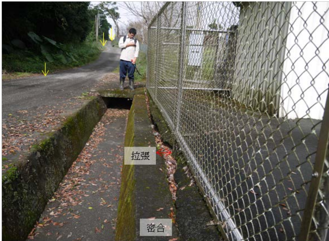
照片 3-4.34、調查點 G7-2 水溝側邊與地板接觸關係由密合到拉張，後方道路呈現波浪狀。
