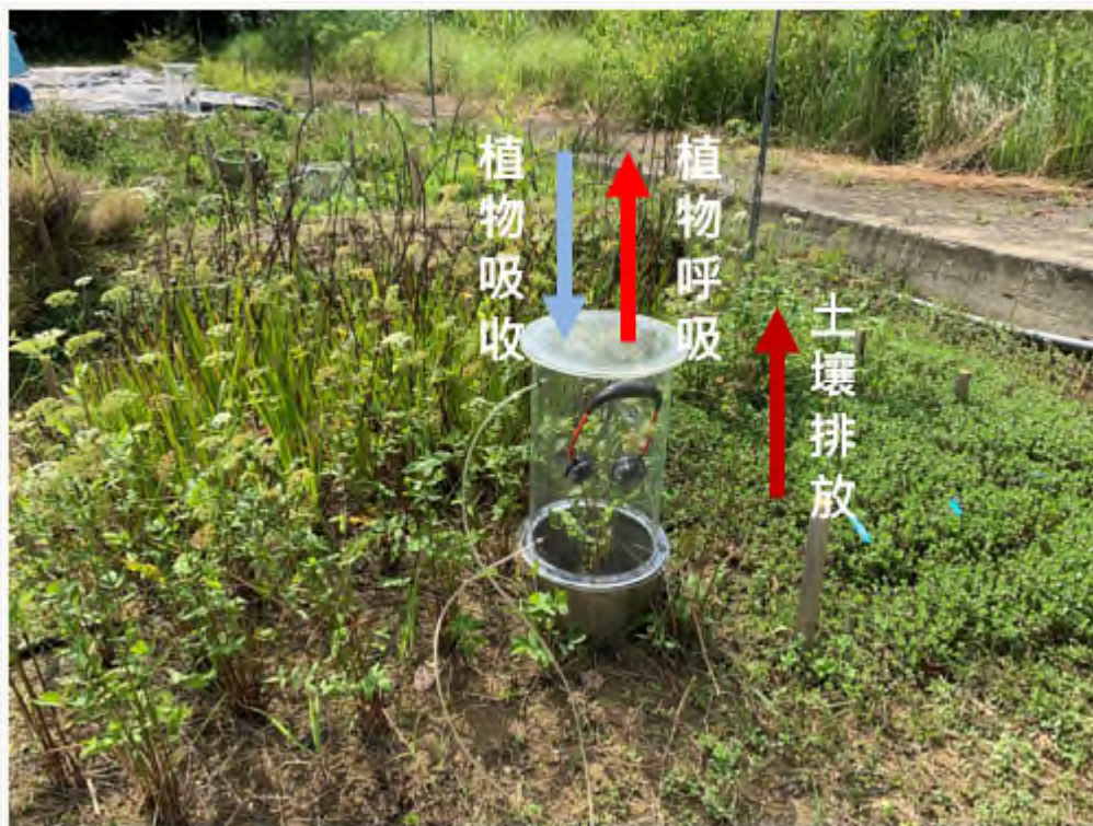
圖 3.2、物種碳通量量測示意圖。
