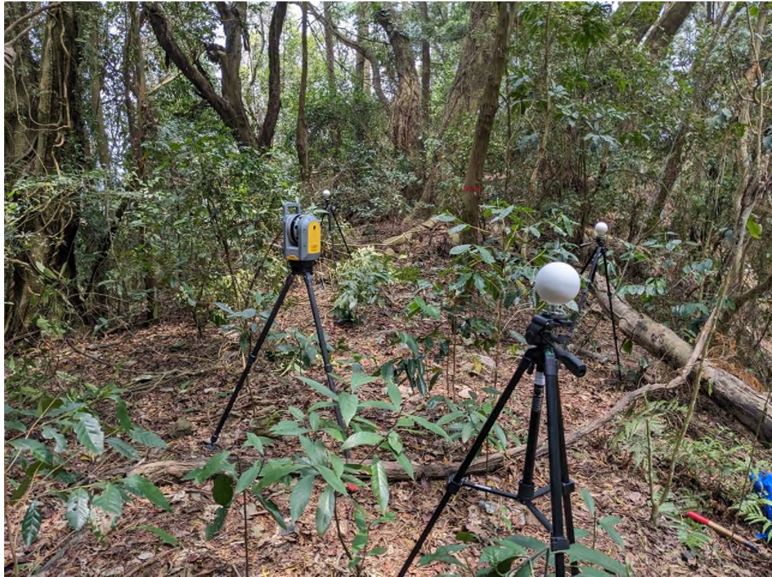
圖 2.1、以 Trimble x7 雷射掃描儀獲取六龜地區臺灣肖楠人工林性態值資訊
