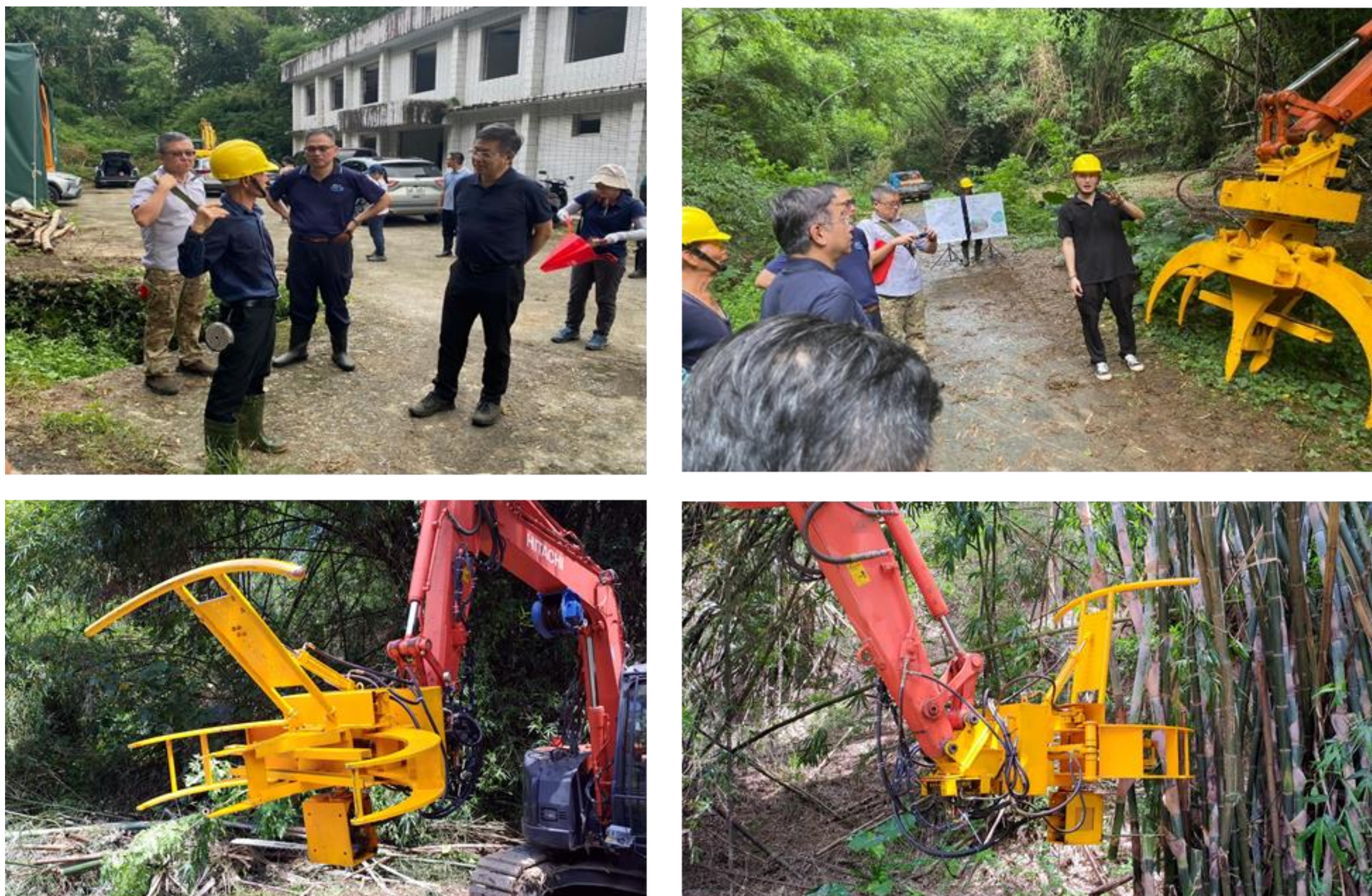
圖2. 伐竹夾具測試及採伐叢生竹多支竹桿
