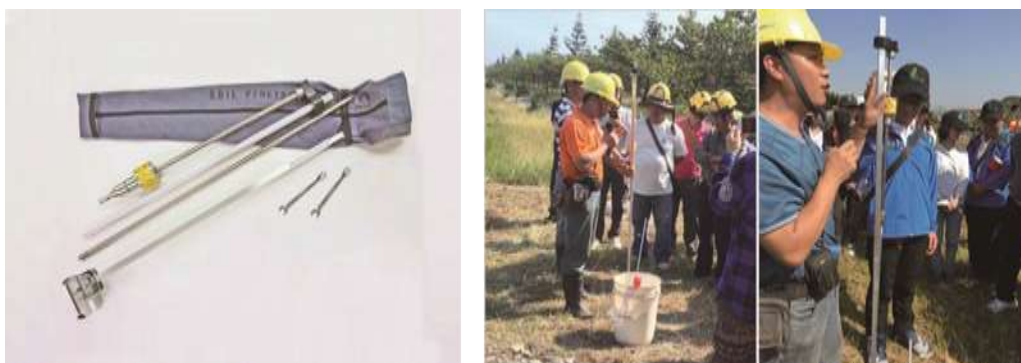
圖 9-12、長谷川氏土壤貫入計方便於檢測垂直土壤結構硬度。
