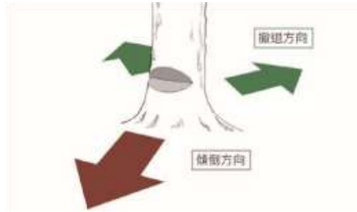
圖 12-1、伐除樹木時，樹木預定傾倒方向的反向 45 度是首選的撤退路線。
