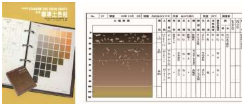
圖 9-10、開挖人工簡易檢土坑，配合人體感官觀察，便可獲得許多土壤結構狀態訊息；或輔以土色表比對，可以解讀更多的土壤基本訊息。
