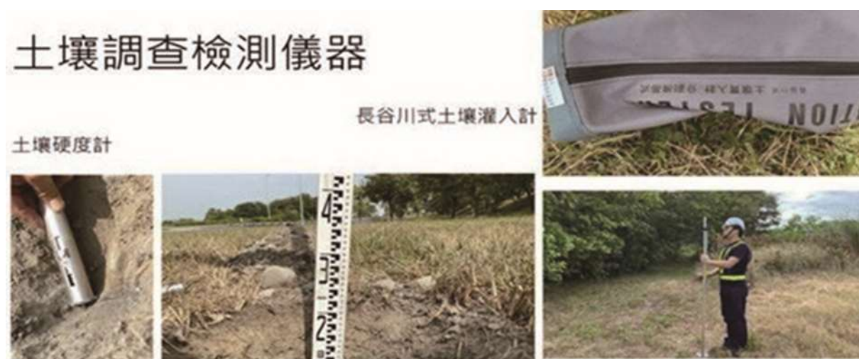
圖 5-5 土壤硬度調查量測工具。
