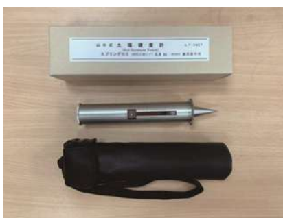
圖 9-11、山中氏土壤硬度計主要係利用尖錐體穿刺進入土壤產生的阻力係數得到土壤的硬度結果。
