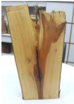
圖 10-4、闊葉樹內生樹皮及木質部腐朽情形。
