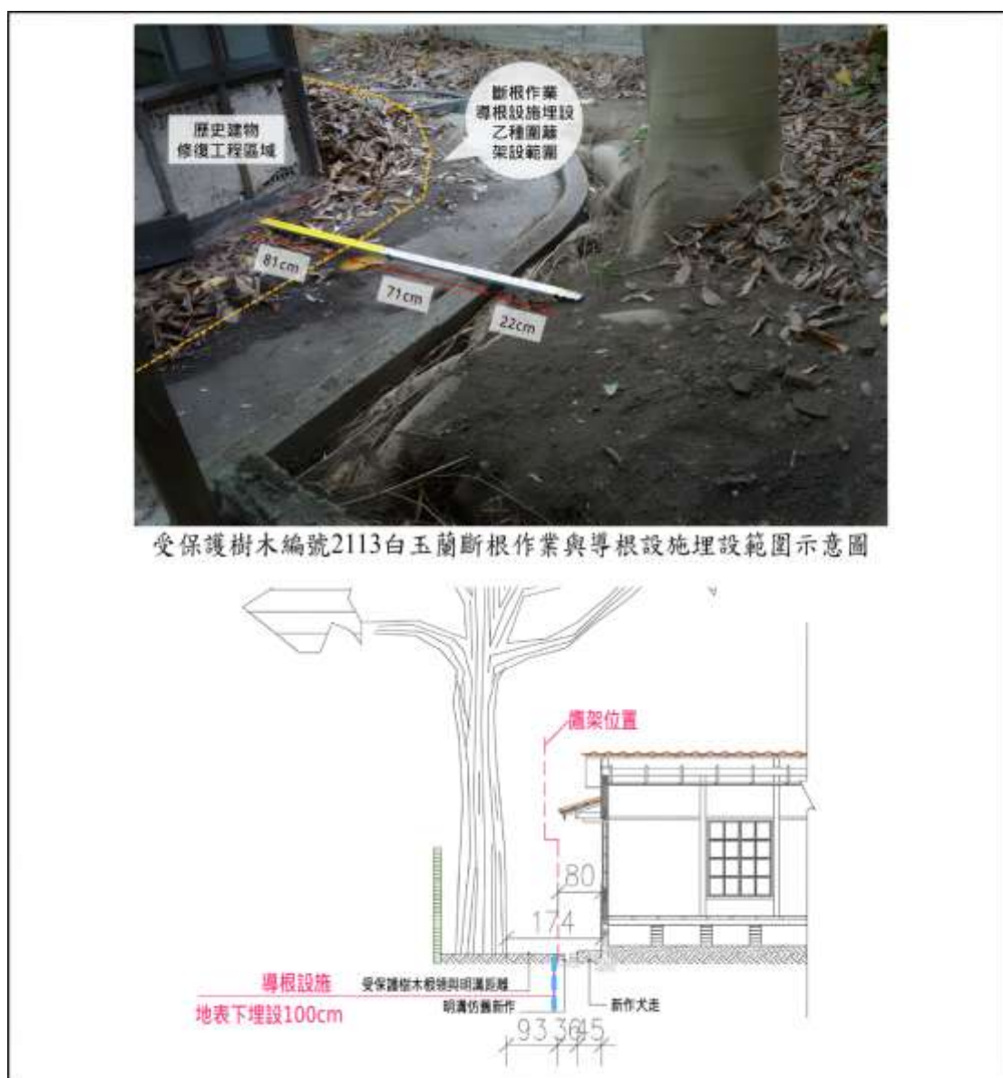
圖 8-10、受保護樹木樹根保護範圍與工法示意圖範例。
