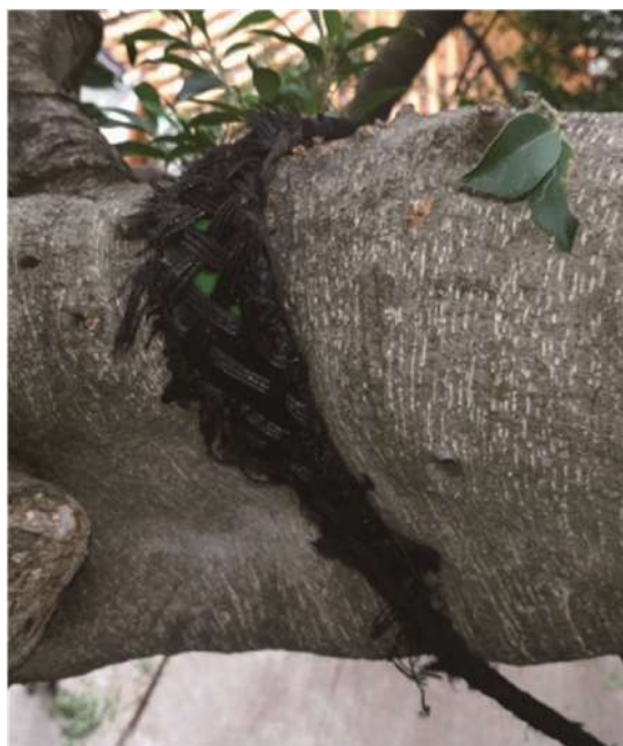
圖 5-7、彈性纜繩的缺點是可能因松鼠啃咬而受損，需要定期檢查與更換。
