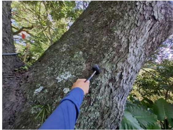
圖 6-40、未達樹心的開空洞診斷。
