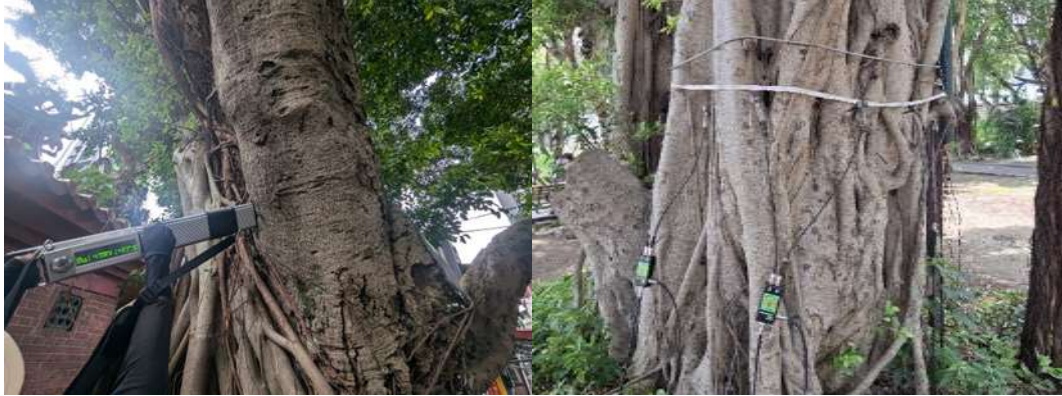
圖 1-15、鑽孔阻抗記錄儀(Resistance-recording drilling)及聲波斷層掃描儀。
