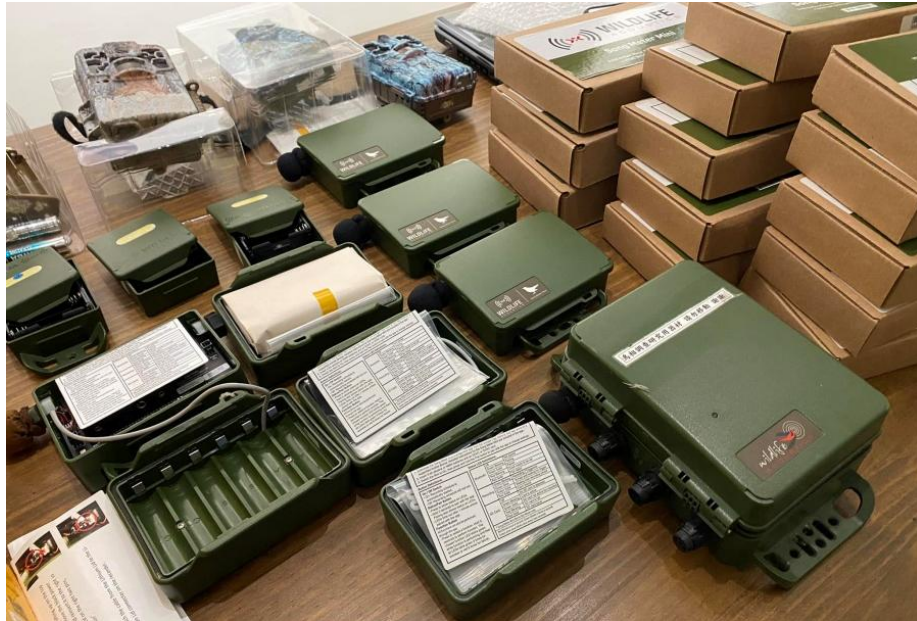
圖 2.1-5、本計畫所使用的自動錄音機(Song Meter Micro/mini)
