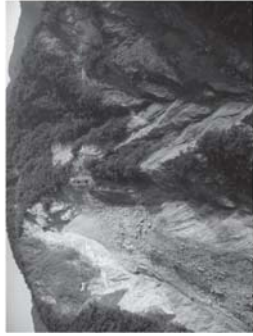
河岸掏刷、坡面崩塌，土石殘留坡面、溪床，尚未運移。
