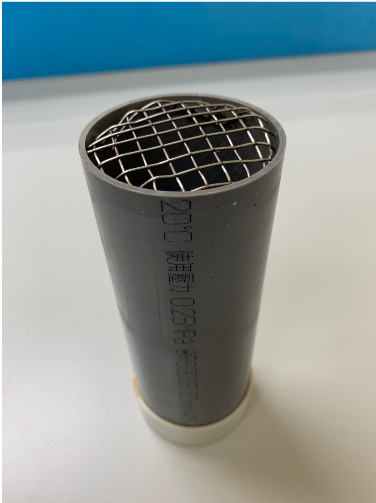
圖 7-10. 收集水體中沈積物用的沈降管。內徑 50 公釐，高 16 公分。
