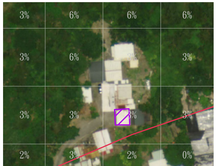
解除區域坡度分析圖 (數字百分比為坵塊法25M分析之平均坡度)
