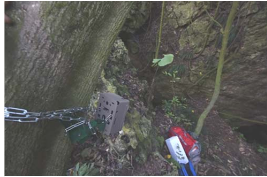
安裝在洞穴出入口的感應式攝影機，可記錄探洞團體在何年何月何時有多少人進入洞穴，在洞穴內停留多久的時間，藉此瞭解遊客的探洞習性。
