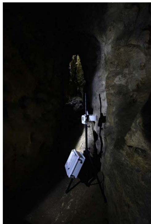
天雨天財洞內的氣象測站，測量溫度、濕度、二氧化碳濃度、風速與風向等資料。
