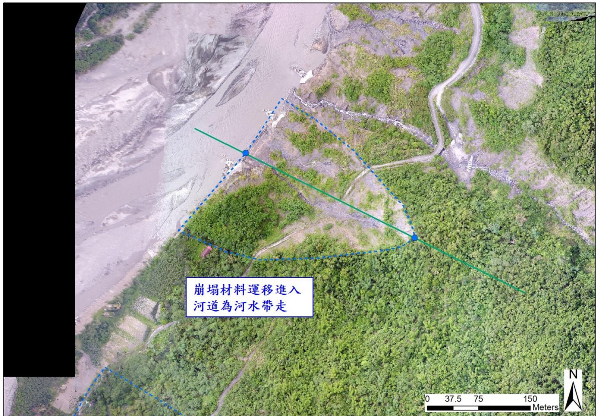
圖 6-11 局部崩塌 2 崩塌影響範圍
