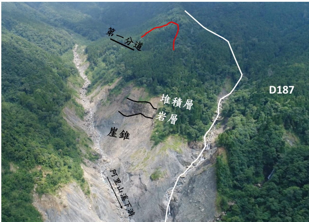
圖 3-109 遠眺下游方向照片 (左岸略呈逆向坡地形，傾角緩；右岸符合大區域層面位態方向)
