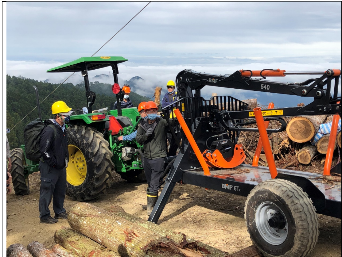
圖 31 裝載式原木拖車裝運材機具作業解說
