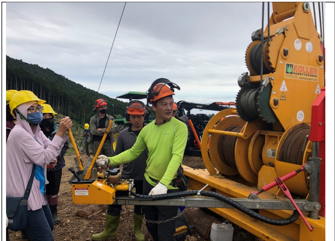
圖 27 塔式集材機集材操作示範與實務操作
