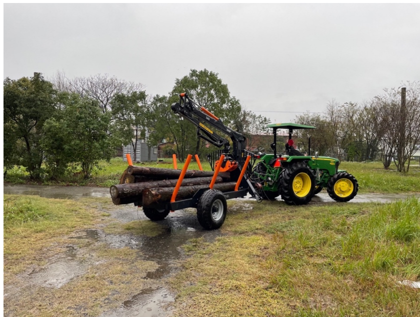
圖 2 John Deere 5005 型曳引機結合 BMF 6T2 之運材作業
