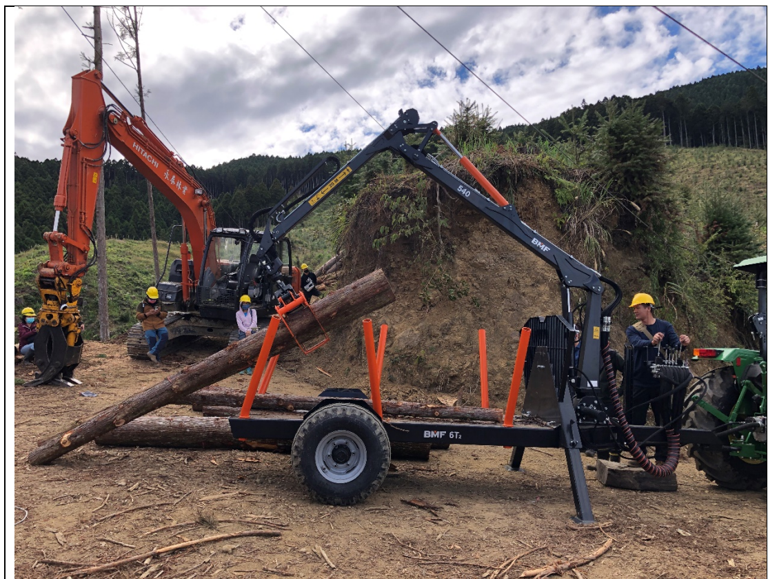
圖 32 裝載式原木拖車裝運材機具實務操作
