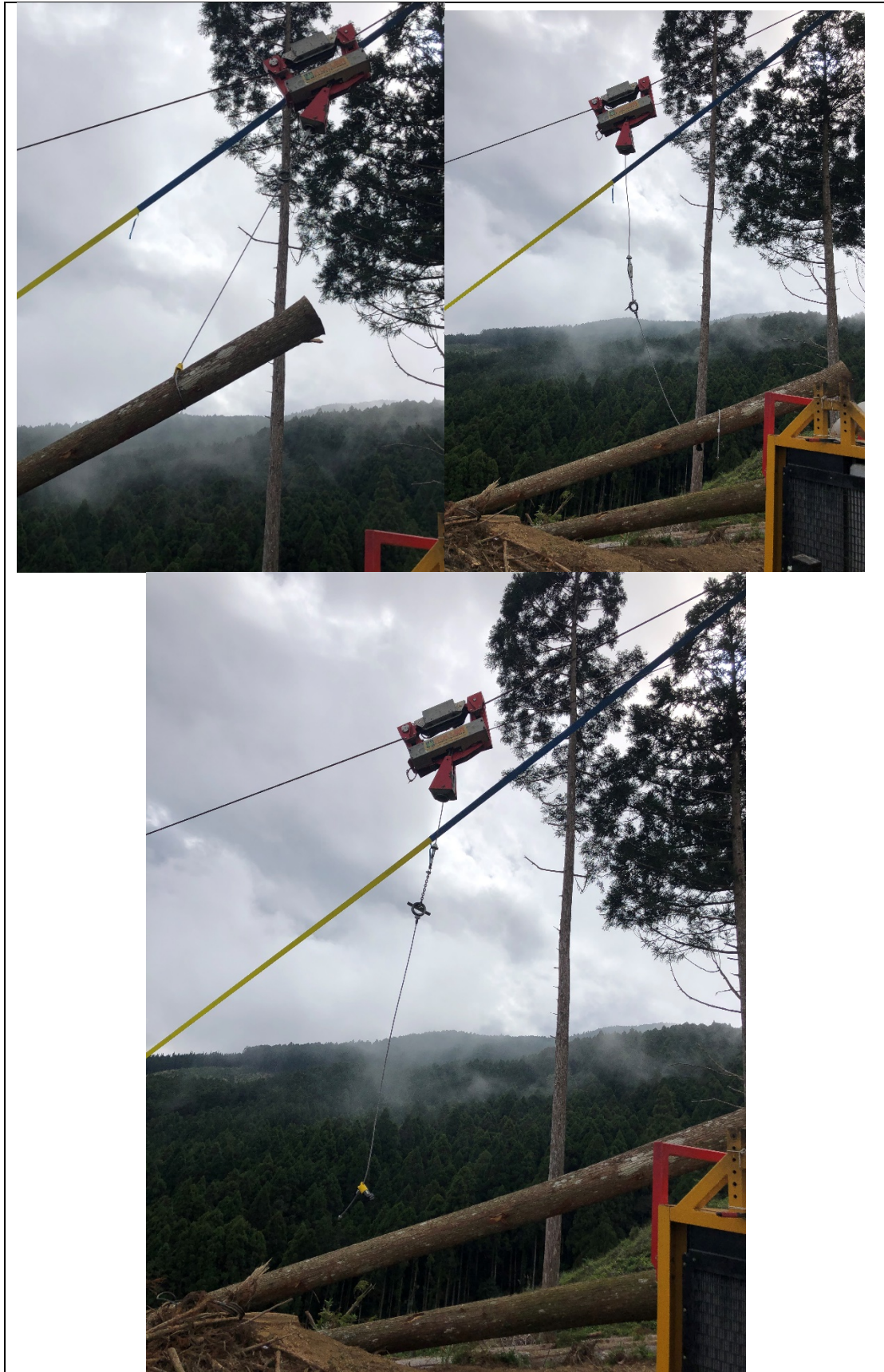
圖 28 自動解材裝置實務操作
