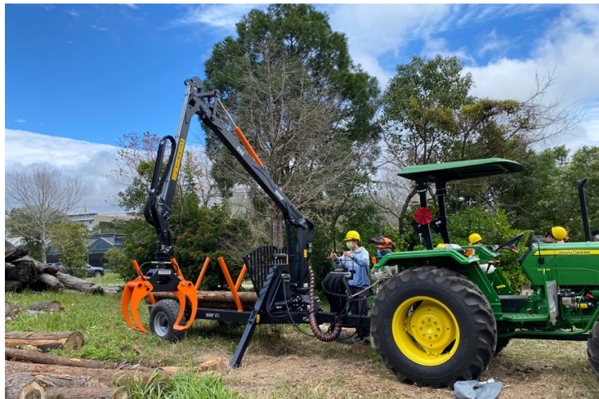
圖 1 John Deere 5005 型曳引機結合 BMF 6T2 之裝材作業
