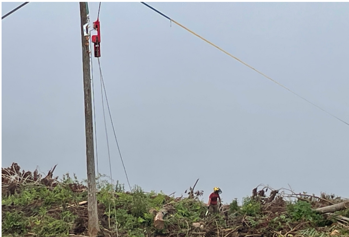
圖 6 竹東事業區第 7 林班收穫作業架設之中間柱與鞍座
